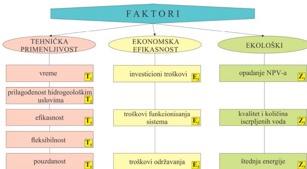
Slika III-76: Faktori uticaja na izbor optimalnog sistema za odbranu od podzemnih voda na primeru površinskog kopa „Buvač”
