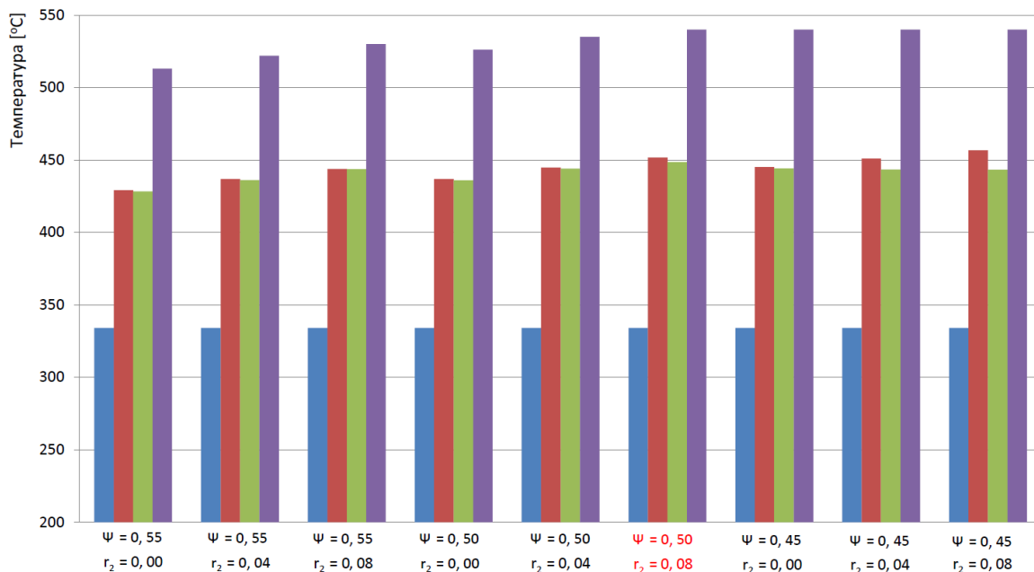
Слика 53. Промена температуре на линији накнадно прегрејане паре при промени степена топлотне ефикасности екрана ложишта и удела рециркулисаних хладних гасова
