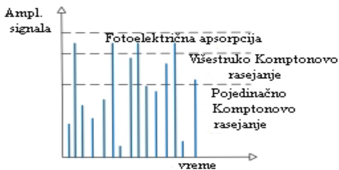
Slika 2. Signali iz detektora koji predstavljaju različite vrste interakcija \gamma -zračenja u detektoru
