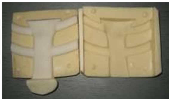
Слика 55. Имплантат изливен у калупу пре завршне обраде
