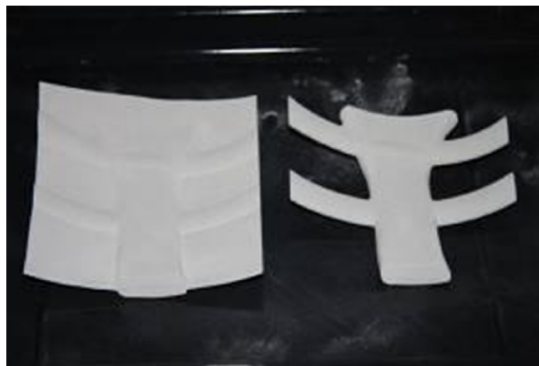
Слика 52. Готови оригинали добијени поступком 3D штампања
