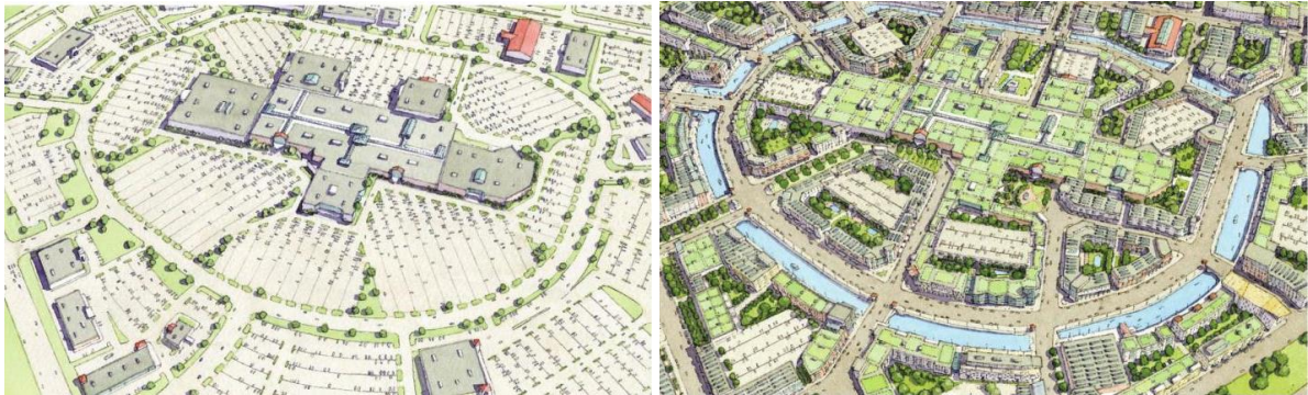
Slika 14a i 14b. 3D prikaz stanja pre i posle transformacije šoping mola - sprawl (levo) i kompletno naselje (desno). Izvor: Tachieva, G.: Sprawl Repair Manual , str.133., Island Press, Washington DC, 2010.
