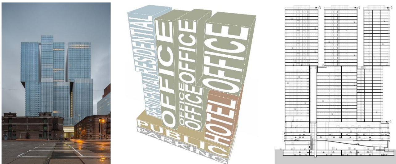
Ilustracija 4.4.7 a) spoljašnji izgled; b) prikaz organizacije funkcionalnih celina; c) podužni presek. Izvor: (Lootsma, 2014)
