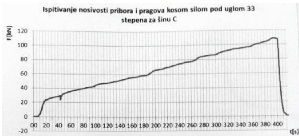
Slika4 245. Dijagram sila-vreme za dejstvo kose sile na vrhu šine
