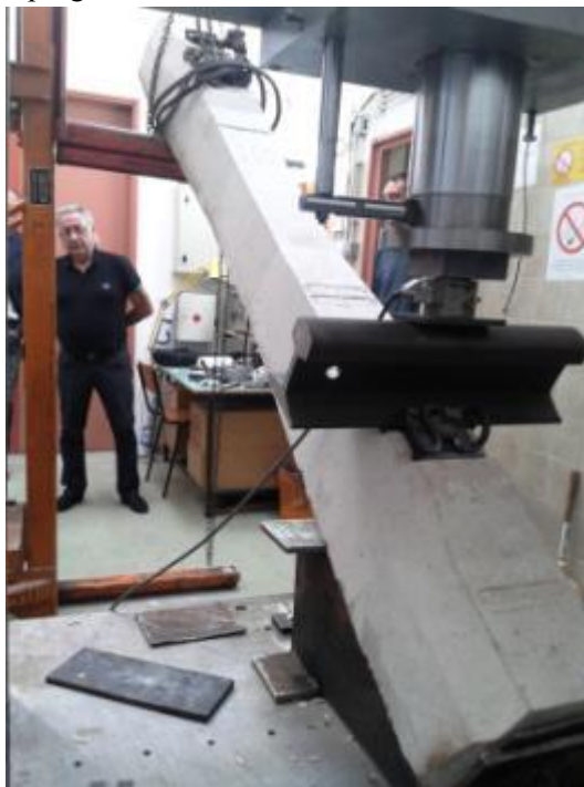
Slika 247. Način ostvarivanja ugla od 33° za dejstvo kose sile na vrhu šine
