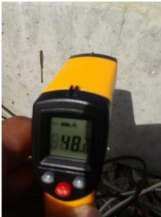
Slika 118. Merenje temperature betona na površini ispitivanog praga posle prolaska kompozicije
