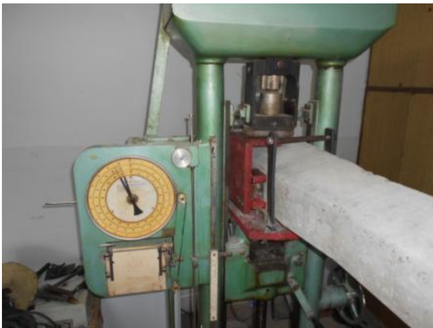
Slika 236. Ispitivanje sile kočenja za kolosečni pričvrсни pribor tipa Pandrol
