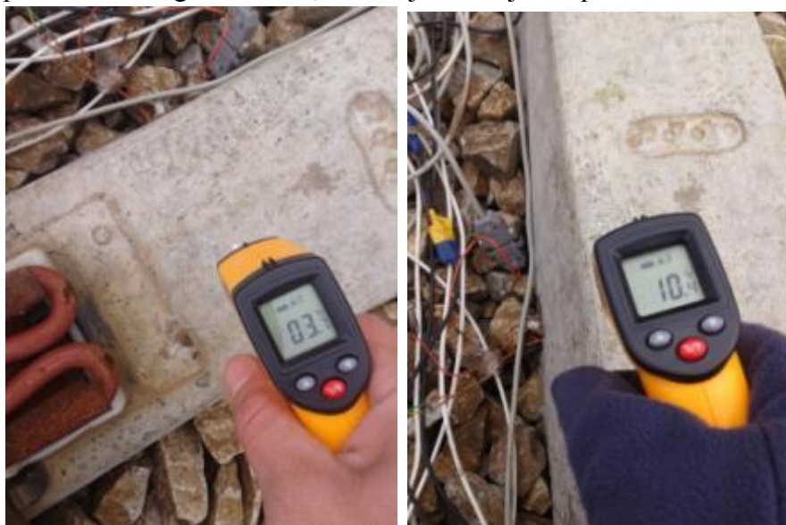
Slika 175a) i 175b) Merenje temperature betona na površini ispitivanog praga posle prolaska kompozicije
