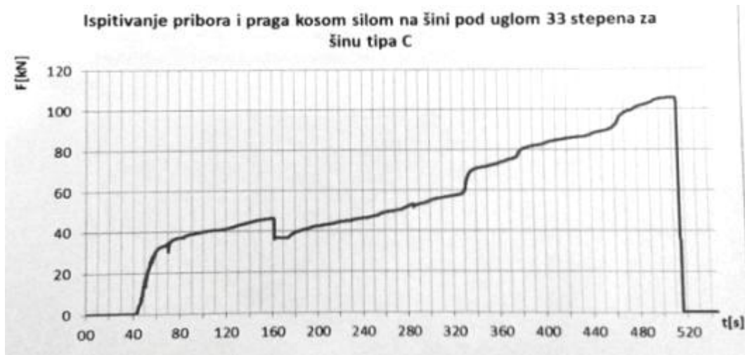
Slika 246. Dijagram sila-vreme za dejstvo kose sile na vrhu šine
