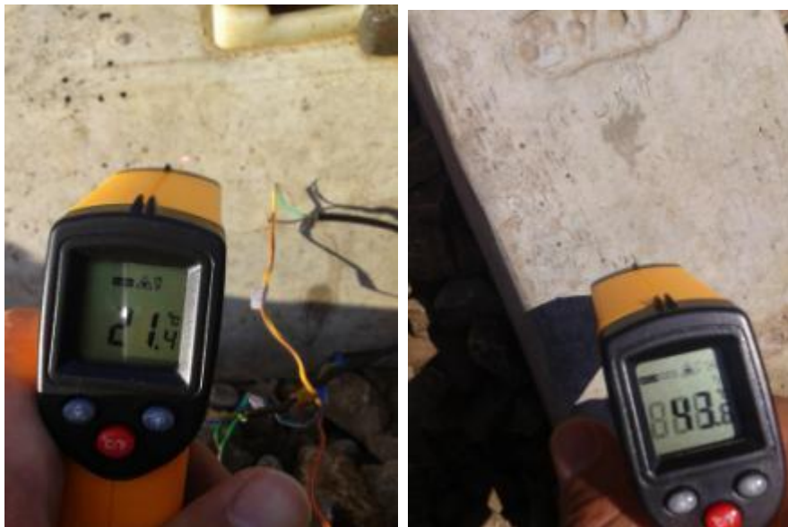
Slika 160a) i 160b) Merenje temperature betona na površini ispitivanog praga posle prolaska kompozicije
