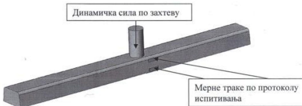
Slika 188. Prag u normalnom položaju - pozitivni moment
