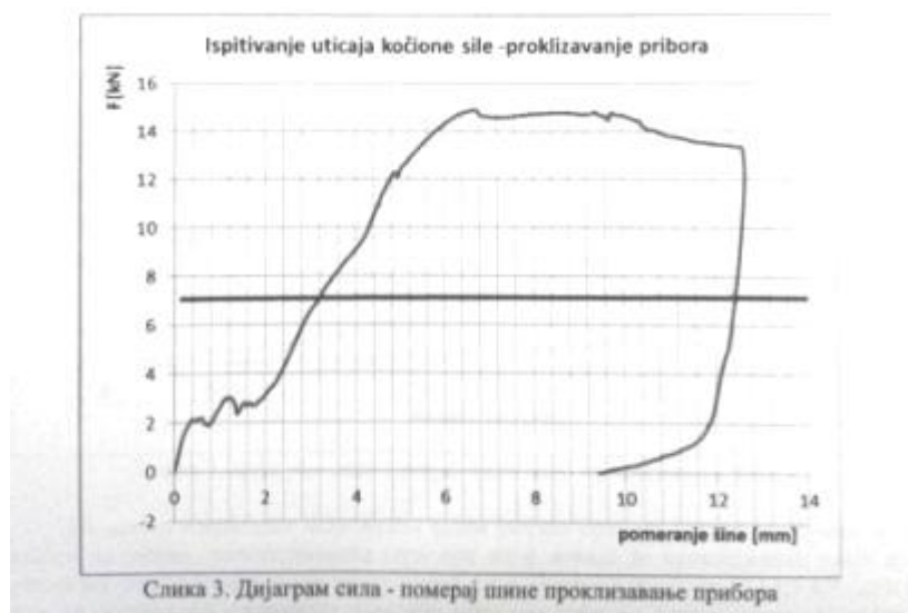
Slika 240. Dijagram sila - pomeranje šine - proklizavanje pribora
