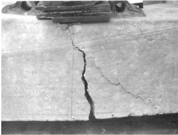
Slika 93. Karakteristična prslina pri dinamičkom opterećenju
