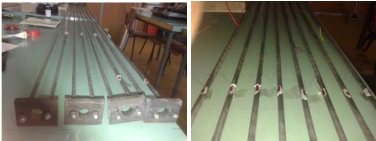
Slika 108.a) i 108.b) Postavljanje mernih traka na žice za prednapreznje prednapregnutog betonskog praga B70, l=260cm
