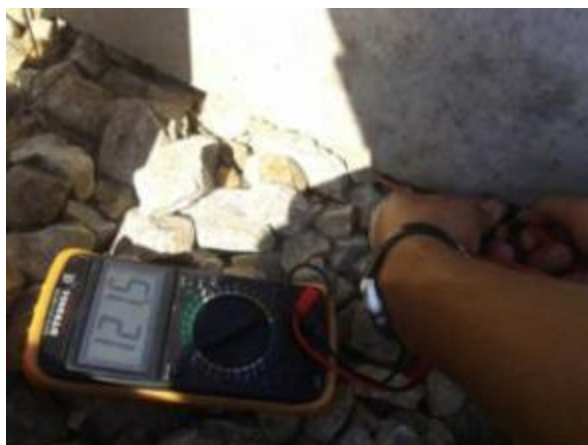
Slika 115. Merenje otpora mernih traka postavljenih u prag B70, L=260cm (multo čitanje)
