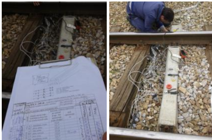
Slika 135. Povezivanje mernih traka i sačinjavanje zapisnika
