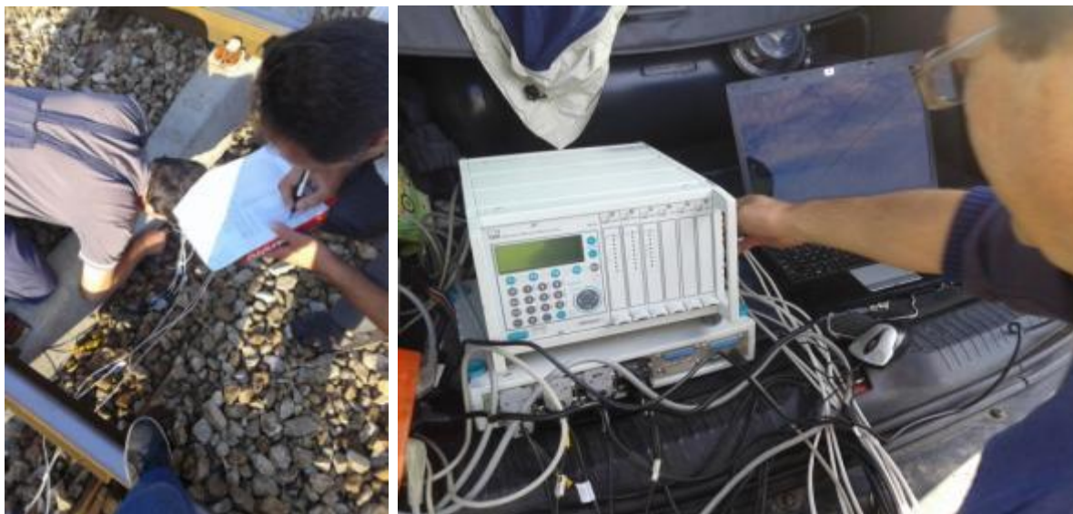
Slika 116. Povezivanje mernih traka i merni instrumenti
