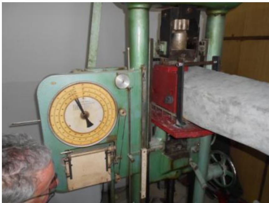
Slika 234. Ispitivanje sile kočenja za kolosečni pričvrсни pribor tipa Vossloh
