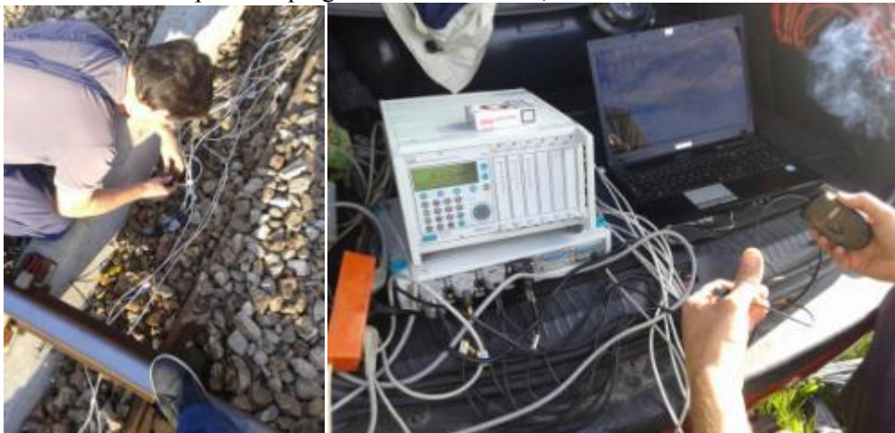
Slika 158. Povezivanje mernih traka i merni instrumenti
