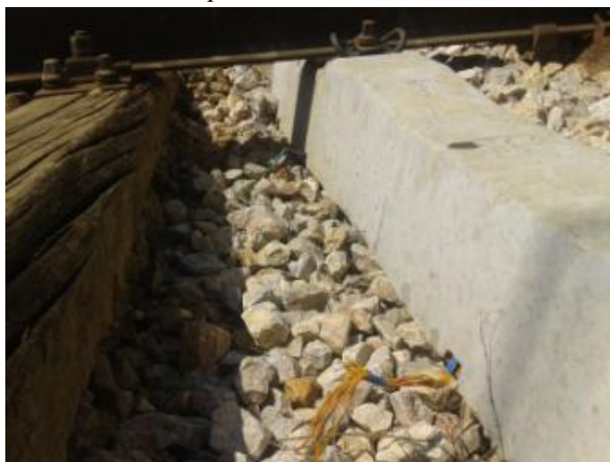
Slika 114. Izvodi mernih traka, prag B70, L=260cm, montiran u kolosek u blizini žel. stanice u Stalaću
