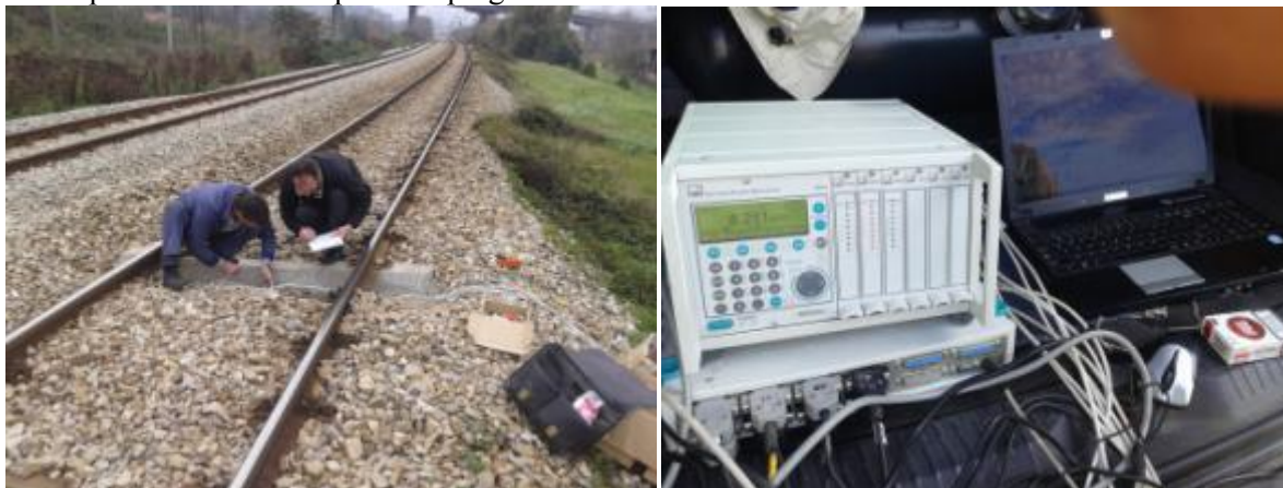
Slika 173a) i 173b). Povezivanje mernih traka i merni instrumenti
