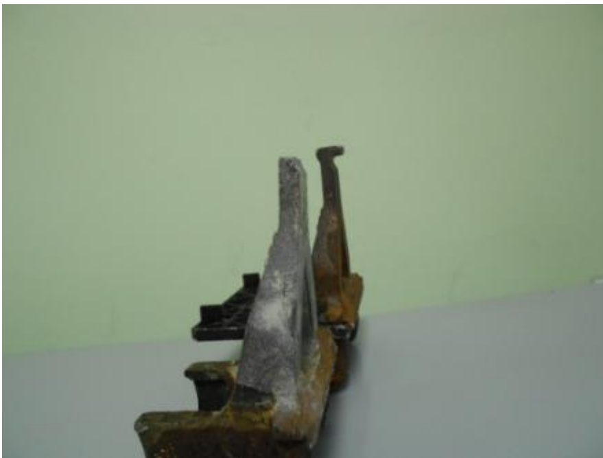
Slika 237. Oštećenje vrha čvorne veze kolosečnog pričvrsnog pribora tipa Pandrol pri uticaju maksimalne sile čupanja od 90 kN
