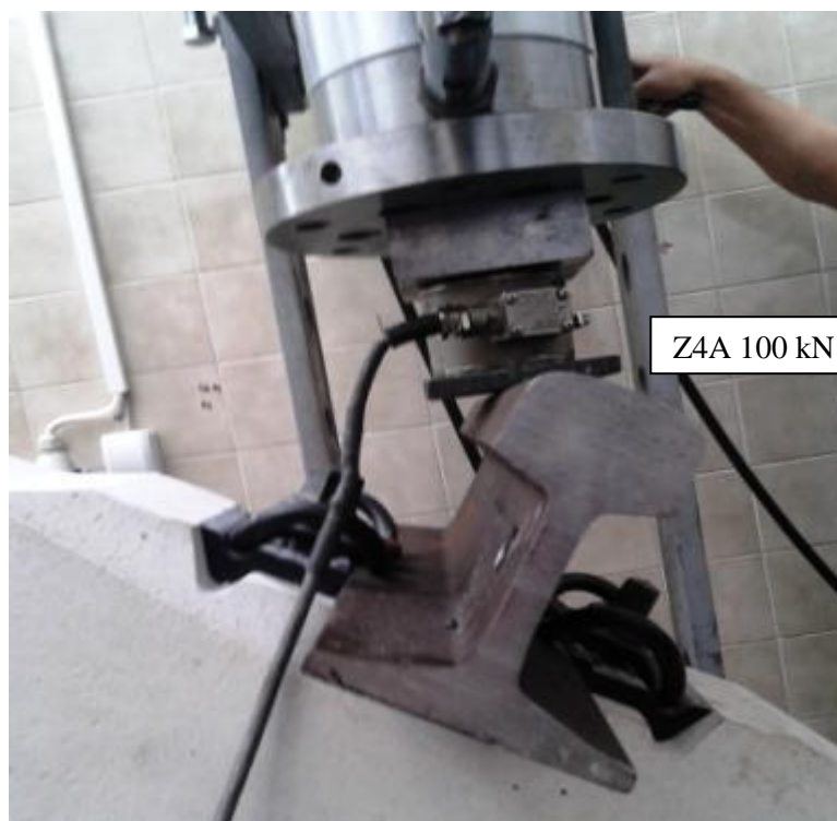
Slika 244. Položaj mernih senzora pri ispitivanju otpora pribora pri kosoj sili
