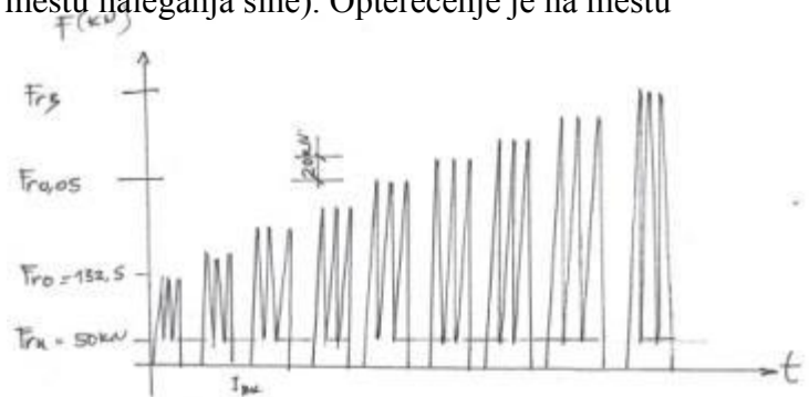
Sl.193. Šema nanošenja dinamičkog opterećenja
