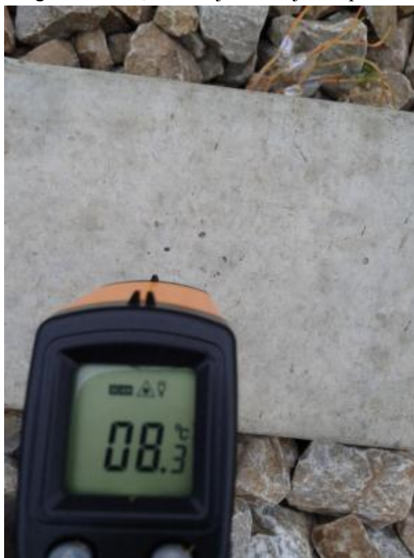
Slika 137. Merenje temperature betona na površini ispitivanog praga posle prolaska kompozicije
