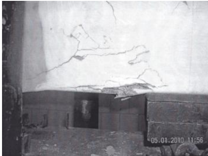
Slika 88. Karakteristični lom pri maksimalnoj sili
