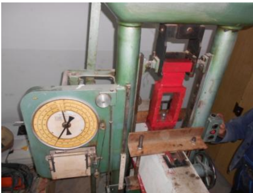
Slika 235. Ispitivanje sile čupanja za kolosečni pričvrсни pribor tipa Pandrol
