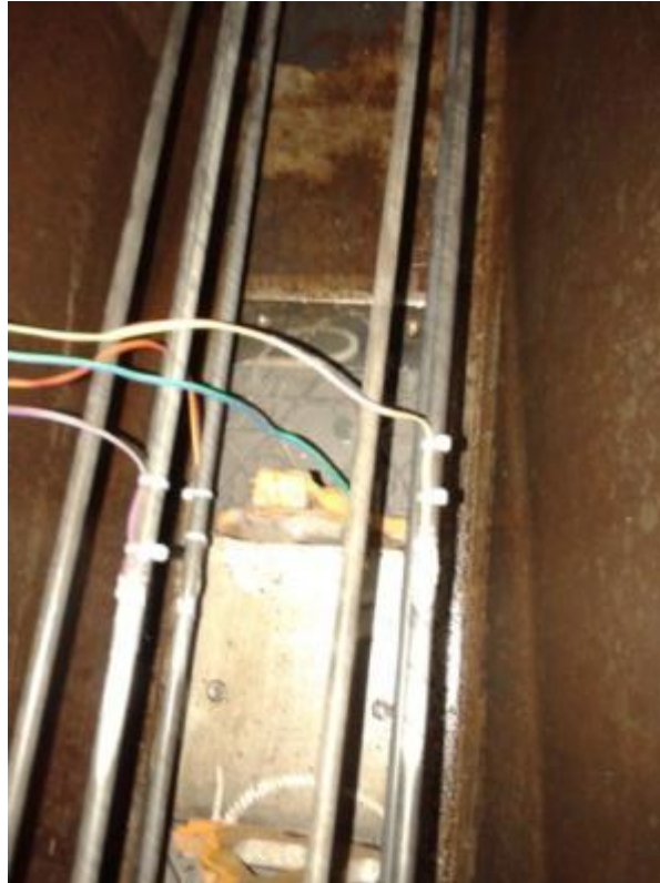
Slika 153. Montaža žica za prednaprezanje sa mernim trakama u kalup prednapregnutog betonskog praga B70, l=240cm
