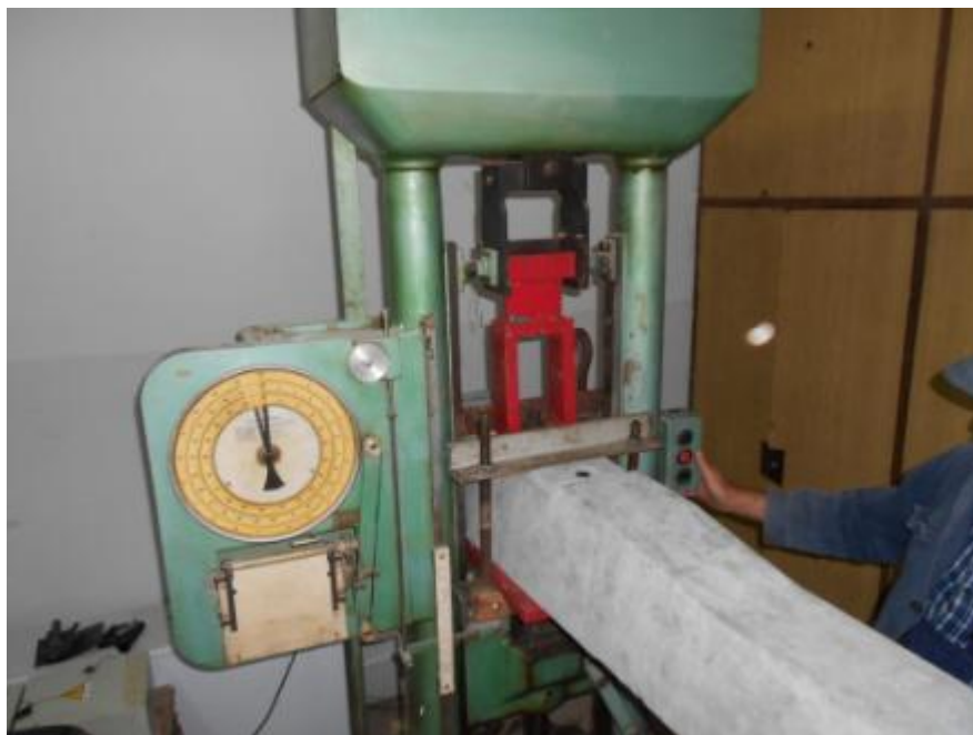
Slika 232. Priprema za utvrđivanje sile čupanja tirfona za kolosečni pričvrсни pribor tipa Vossloh
