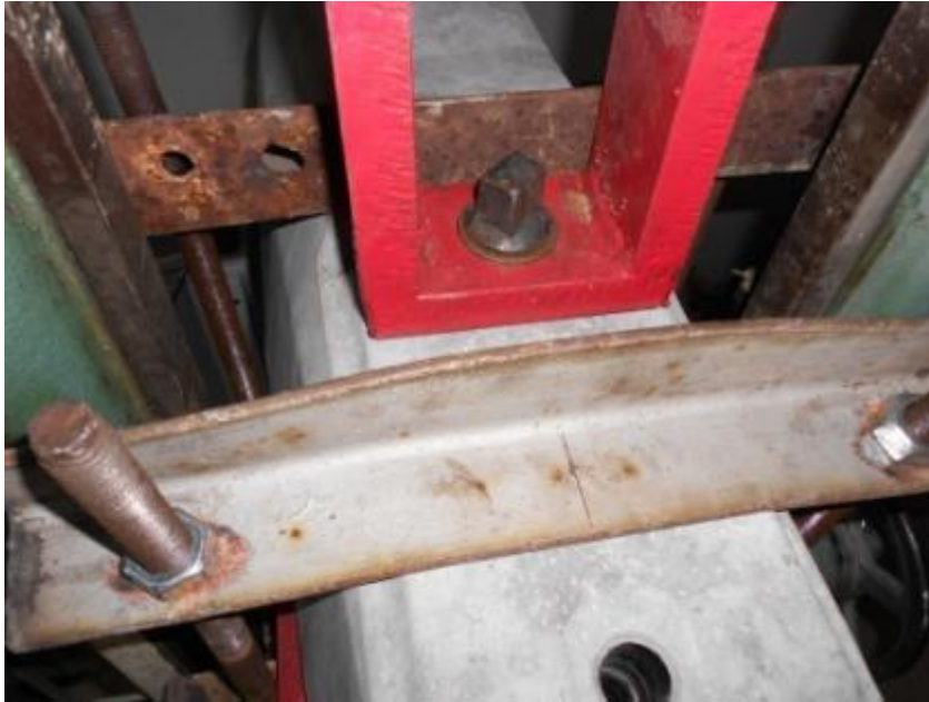
Slika 233. Ispitivanje sile čupanja za kolosečni pričvrсни pribor tipa Vossloh
