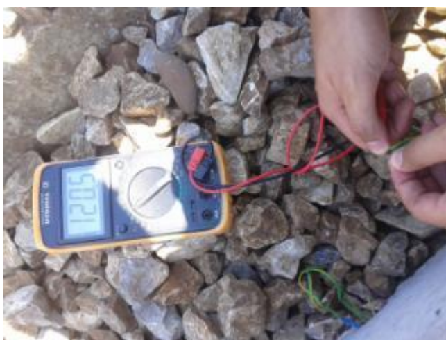
Slika 157. Merenje otpora mernih traka postavljenih u prag B70, L=240cm (multo čitanje)
