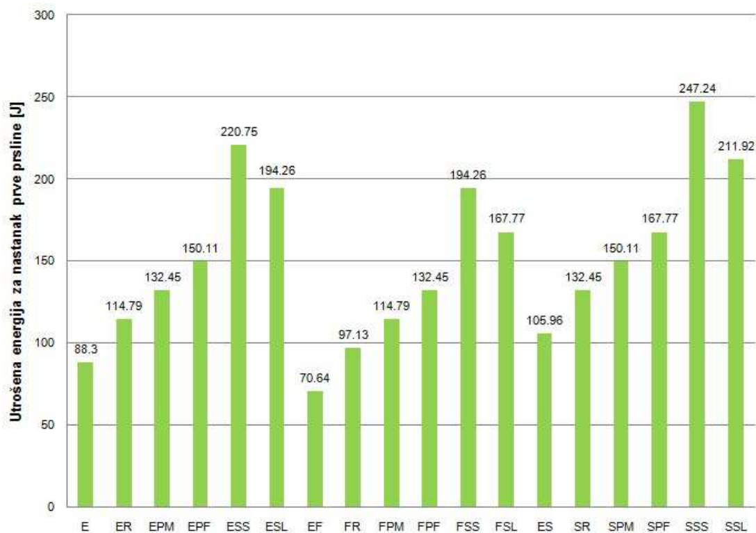
Slika 6.6. Količina utrošene energije za nastanak prve prsline prilikom ispitivanja udarne otpornosti betona – metodom „Drop-weight“
