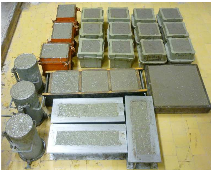
Slika 5.9. Svež beton ugrađen u kalupe
