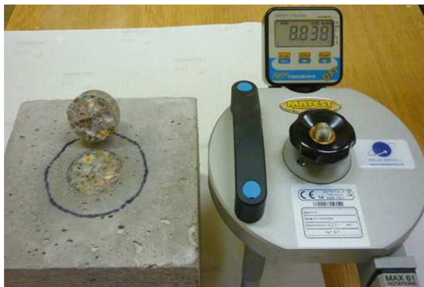
Slika 5.21. „Pull-off“ aparatura i uzorak betona nakon ispitivanja
