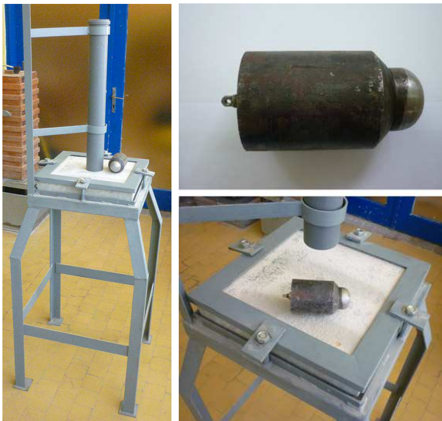
Slika 5.30. Dispozicija ispitivanja udarne otpornosti betona – metodom „Drop-weight“
