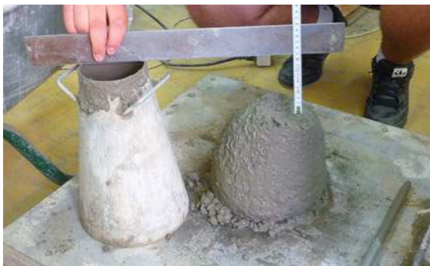
Slika 5.10. Ispitivanje konzistencije betona metodom sleganja (pomoću Abramsovog konusa)
