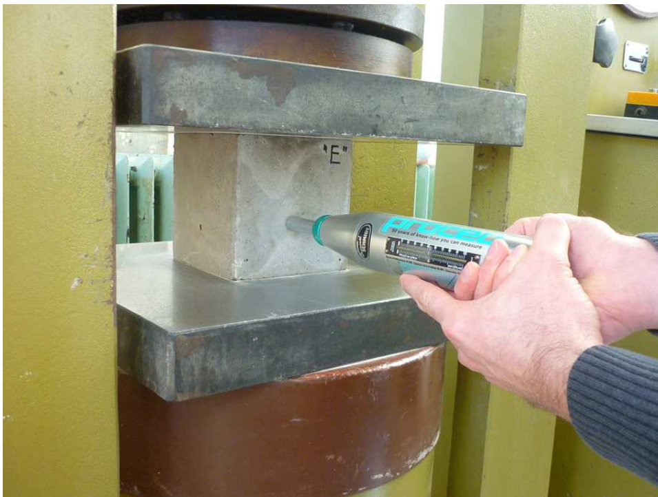
Slika 5.25. Određivanje odskočnog broja upotrebom sklerometra
