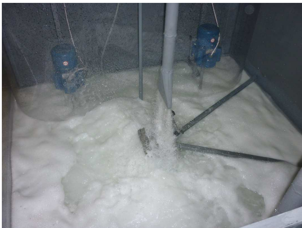
Slika 8.4.4. Aparatura za ispitivanje hidro-abrazivne otpornosti betona u pogonu
