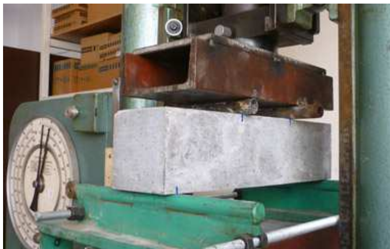
Slika 5.15. Određivanje čvrstoće pri savijanju očvrslog betona
