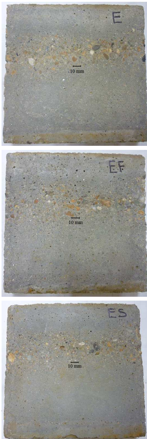
Slika 5.39. Izgled površine uzorka betona serije E, EF i ES nakon ispitivanja hidro-abrazivne otpornosti
