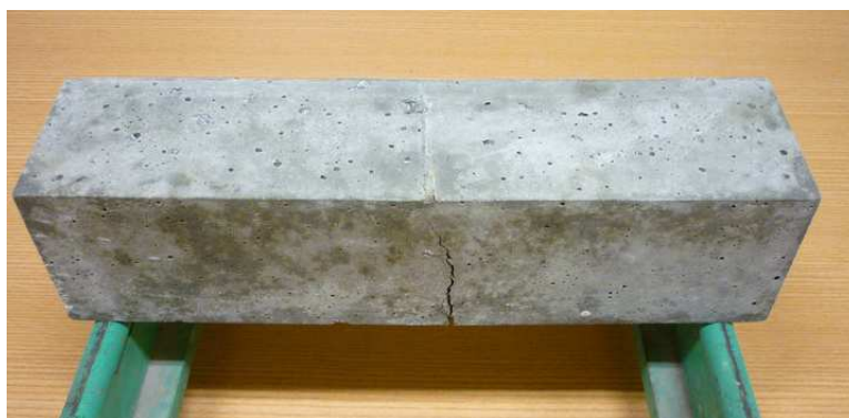
Slika 5.17. Uzorak mikroarmiranog betona nakon ispitivanja čvrstoće pri savijanju
