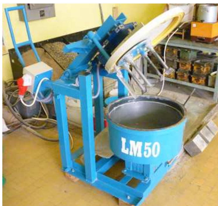
Slika 5.7. Laboratorijska protivstrujna mešalica „Metalika“ Sopot
