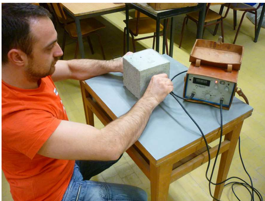
Slika 5.23. Određivanje brzine prolaska ultrazvučnog impulsa kroz beton
