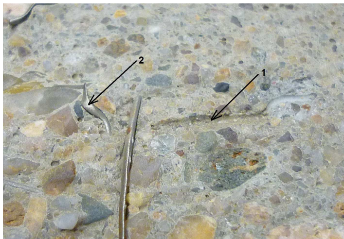
Slika 5.40. Površina uzorka betona mikroarmiranog čeličnim vlaknima ZS/N – 0,50x30mm: 1 – udubljenje od vlakna, 2 – kidanje vlakna
