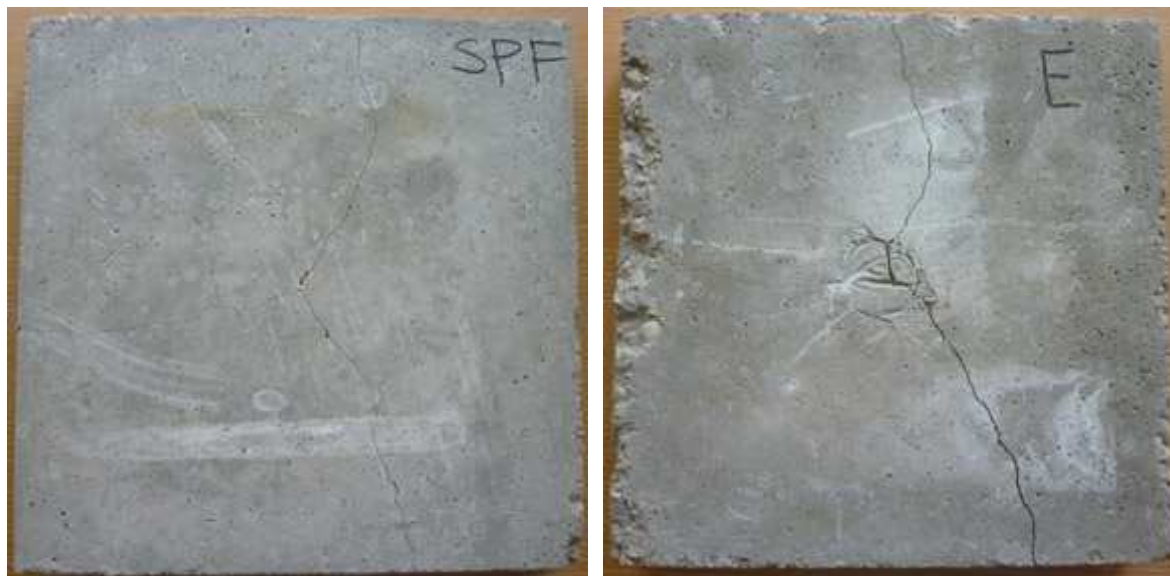
Slika 5.31. Izgled uzorka serije SPF i E nakon ispitivanja udarne otpornosti – metodom „Drop-weight“
