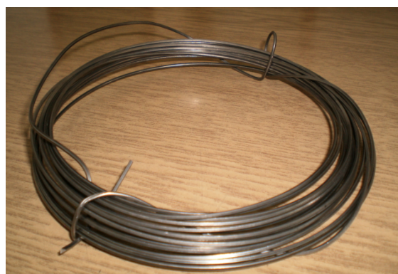
Слика 6.11. Изглед узорка легуре PdNi5 након ваљања, топљења и ливења у атмосфери вакуума
