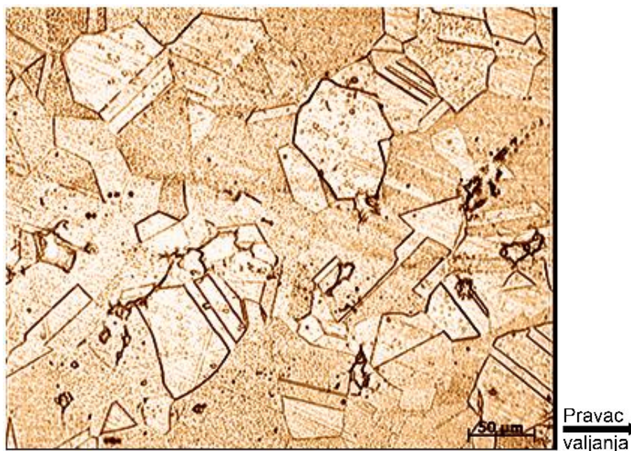
Slika 61.- Uzorak „L-1”, grupa II, ta ka: „O.S.” – 115.40HV0.25, po etna ta ka na dijagramu sl.55. Krupnozrna kompleksna struktura etvorokomponentne legure. Obrada uzorka prema ta . 6.3.3
