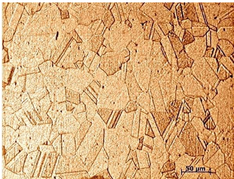
Slika 127.- Legura „L-1“, žareno stanje. Neposredno pored mesta lemljenja gasom. Krupnozrna rekristalizovana struktura, sa velikim brojem dvojnika. Uve anje x200
