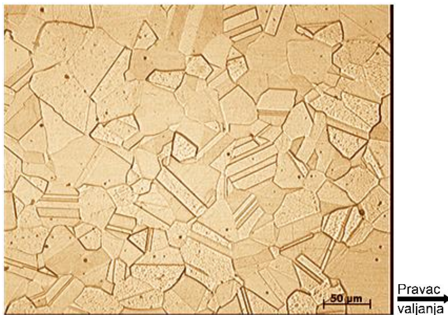
Slika 62.- Uzorak „L-1”, grupa II; Elementi obrade: temperatura t = 200^{\circ}\text{C} , vreme = 30 min, hla enje na vazduhu, ostvarena tvrdo a 169,80HV0.25, sl.55 i 56. Uve anje: \times 200 . Maksimum ostvarene tvrdo e na dijagramu, sa krupnozrnom strukturom i sa velikim brojem dvojnika žarenja
