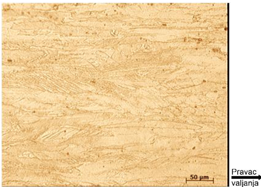
Slika 59.- Uzorak „L-1”; grupa I. Elementi obrade: temperatura t = 200^{\circ}\text{C} , vreme = 30 min, hla enje na vazduhu, ostvorena tvrdo a 251.00HV0.25, na sl. 53 i 54; maksimalno ostvorena tvrdo a na dijagramu. Uve anje: x200. Izražena usmerenost zrna u pravcu valjanja, sa istaknutom pojavom dvojnika žarenja
