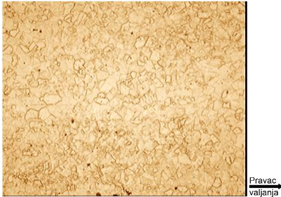
Slika 60.- Uzorak „L-1”; grupa I. Elementi obrade: temperatura t = 550^{\circ}\text{C} , vreme = 30 min, hla enje na vazduhu, ostvorena tvrdo a 118.20HV0.25, sl.53. Uve anje: x200. Završena rekristalizacija uzorka sa sl. 58, sa veoma finom sitnoznom strukturom koja se javlja rekristalizacionim žarenjem nakon hladne deformacije
