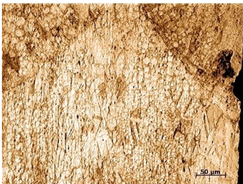
Slika 125.- Legura „L-1“. Lim hladno deformisan, = 30% i zavarjen laserom; vidljivi razli iti oblici zrna pri lokalnom zagrevanju. Uve anje x200
