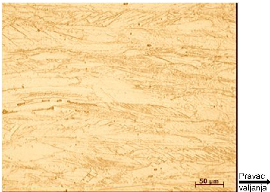
Slika 58.- Uzorak „L-1”- grupa I; Ta ka: „O.S.”-193.00HV0.25; Po etna ta ka na dijagramu sl.53, hladno-valjani lim sa stepenom deformacije = 66,6%; uve anje: x200. Iizdužena zrna u pravcu deformacije valjanjem
