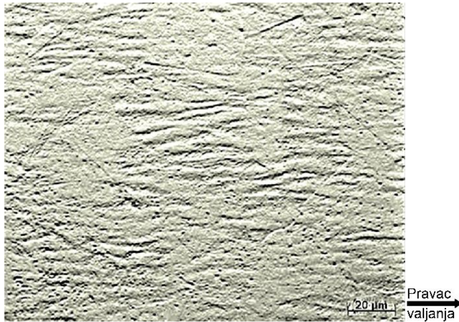
Slika 77.- Uzorak „L-2”- grupa II, ta ka: isto kao na slici 76. Uve anje: x500. Vidljivo nekoliko zrna rekristalizovane kompleksne strukture Au-Ag-Cu-Zn-Pd legure, kao i formiranje lamelarne structure
