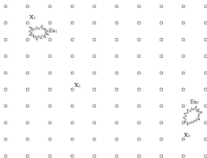
Slika 4: Bežična senzorska mreža za otkrivanje eksplozija. Senzori na čvoru X_1 otkrivaju velike promene usled eksplozije Ex_1 , ali ne detektuju nikakvu promenu pri eksploziji Ex_2 . Senzori na čvoru X_3 detektuju veliku promenu pri eksploziji Ex_3 , ali ne detektuju eksploziju Ex_1 . Senzori na čvoru X_2 detektuju male promene pri obe eksplozije.
