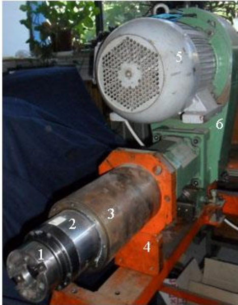
Slika 5.1 Izgled eksperimentalnog modela – 1 glavno vreteno, 2 aksijalno pokretna čaura – pinola, noseća čaura, postolje, pogonski elektromotor, prenosnik glavnog kretanja
