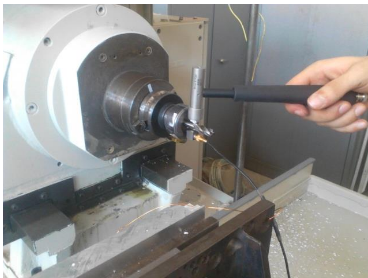
Slika 6.18 Eksperimentalno određivanje modalnih parametara glodala \Phi 10
