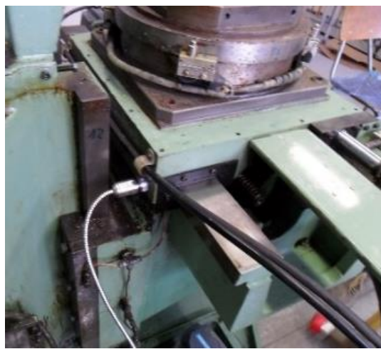
Slika 6.3 Podešavanje eksperimenta pri eksperimentalnom identifikovanju AF karakteristike klizača X ose
