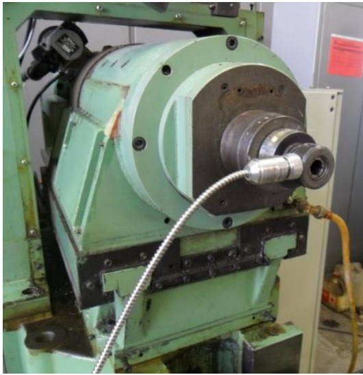
Slika 6.14 Mjerenje vibracija glavnog vretena
