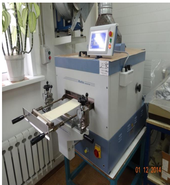
Slika 26. Laboratorijska peć LTF-S, verzija V4.01, Werner Mathis AG, Switzerland
