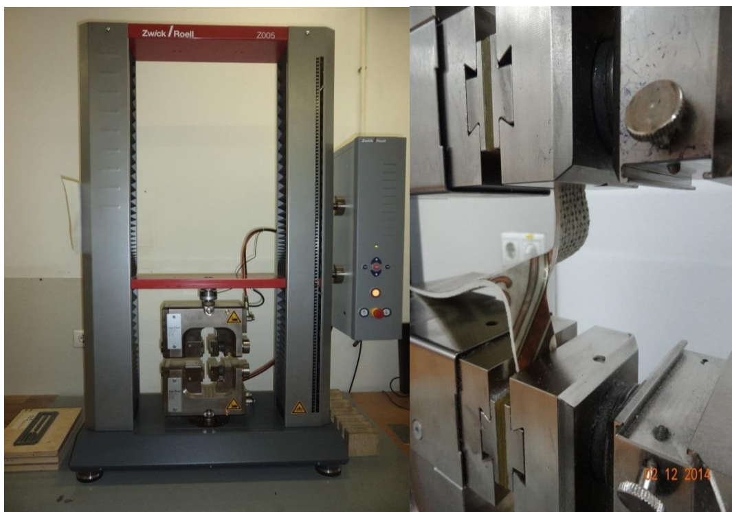
Slika 32. Određivanje početnog otpora cepanju, F_{initial} i otpora cepanju, F_{tear} na laboratorijskom uređaju Zwick Roell Z005
