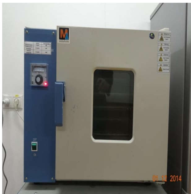
Slika 29. Laboratorijska sušnica Milaform, tip ŠSL-43/250, Rusija
