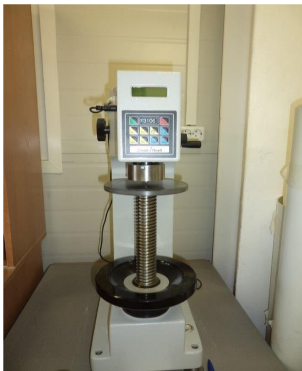
Slika 33. Laboratorijski uređaj Zwick 3106 za određivanje ukupne i zaostale deformacije kao i povratne elastičnosti
