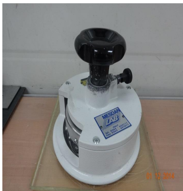
Slika 34. Laboratorijski nož za isecanje kružnih uzoraka, MESDAN-Italy
