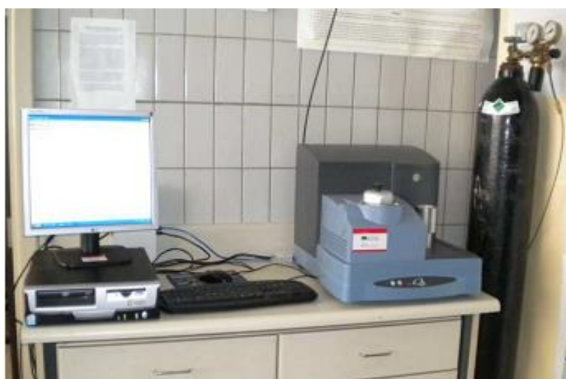
Slika 38. Diferencijalni skenirajući kalorimetar, DSC Q20, TA Instruments
