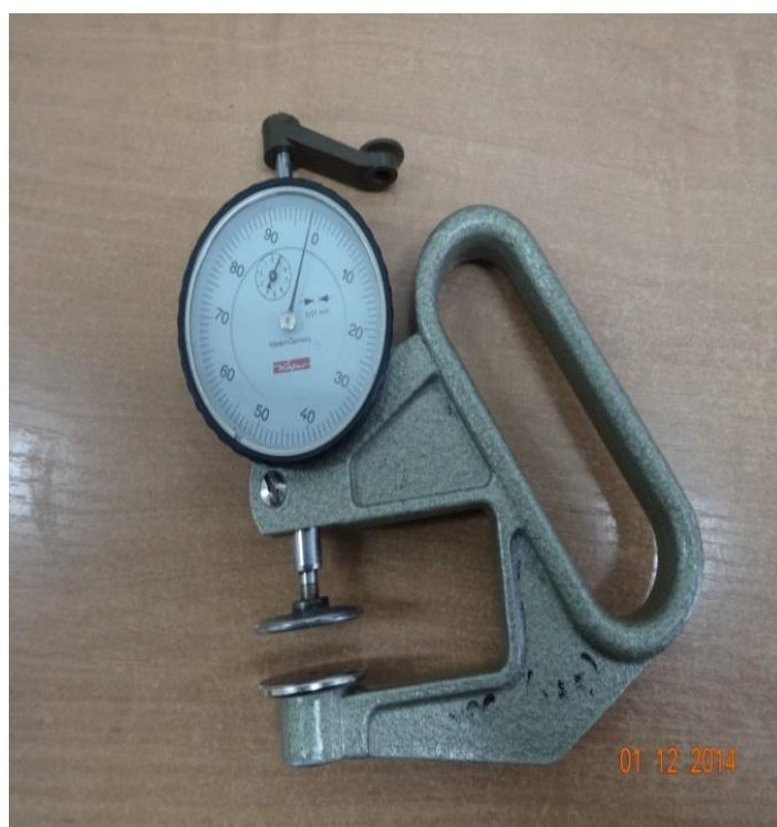
Slika 27. Laboratorijski, mehanički merač debljine, tip J50, Kaefer, Germany
