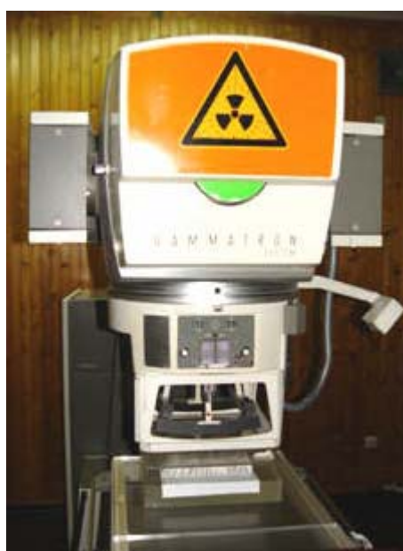
Slika 23. Izvor \gamma -zračenja (TCT Gammatron S 65-K) kojim je ozračivano seme odabranih genotipova soje niskim dozama zračenja
