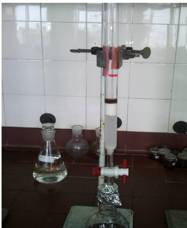
Slika 20. Hromatografska kolona sa formiranim adsorpcionim stubom i uzorkom.
