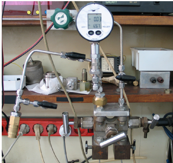
Slika 5.17 - Merna metoda. Pritisak je meren manometrom firme Keller sa opsegom merenja do 200 bar [27].
