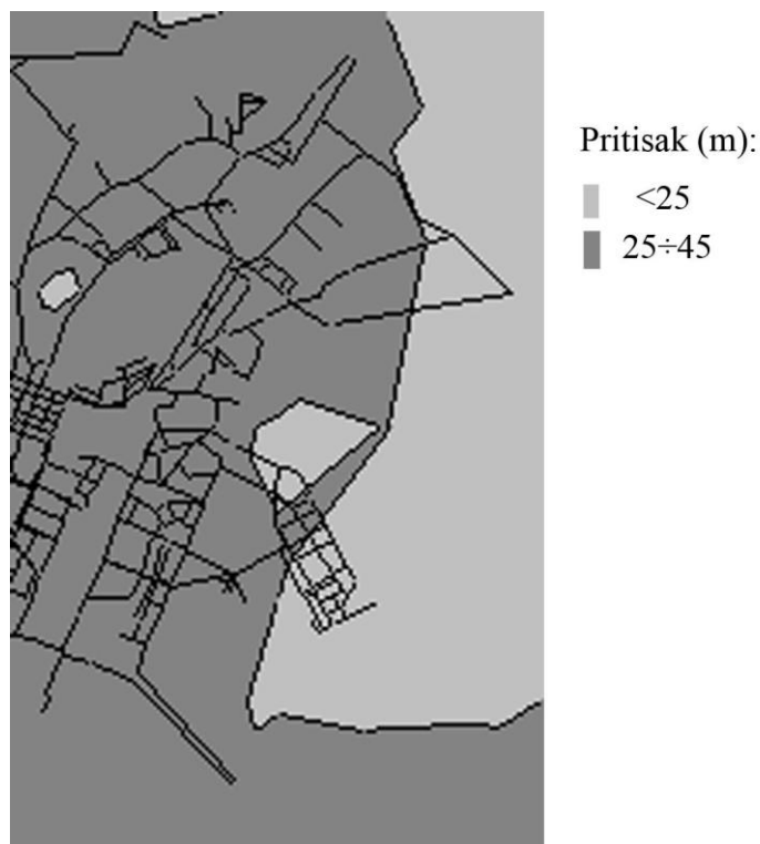
Slika 5.16 Šema dijela vodovodne mreže sa 2 OZB u satu maksimalne potrošnje, sa prikazanim zonama pritiska
