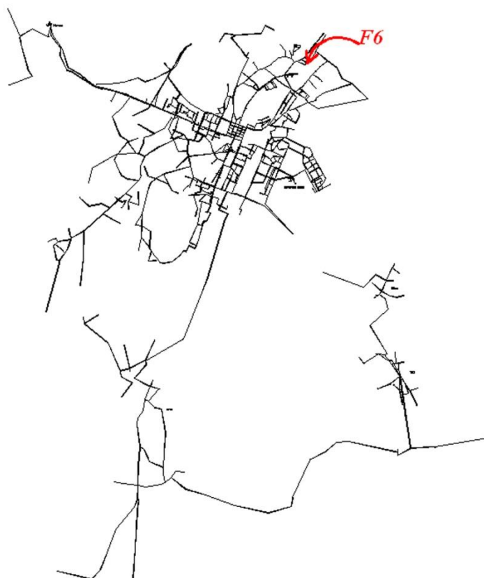
Slika 5.8 Šema sistema sa naznačenim položajem mjernog mjesta F6
