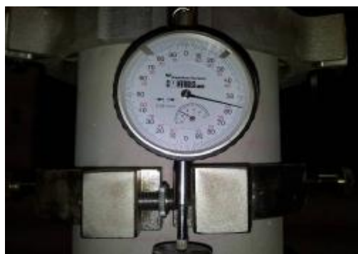
Slika 4.11 Upotrebljen ugibomer sa podatkom 0.001 mm
