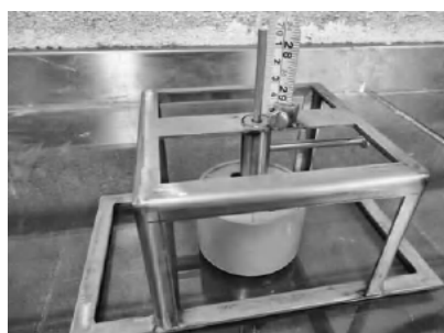
Slika 3.17 Aparat za ispitivanje penetracije kod SCC [64]
