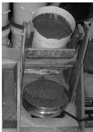
Slika 3.15 Izgled aparature za test otpornosti prema segregaciji sitom [39],[64]
