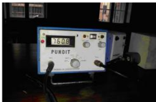
Slika 4.13 Aparatura za određivanje brzine prostiranja ultrazvučnog impulsa kroz beton
