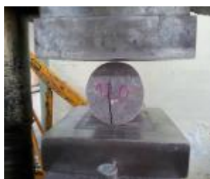
Slika 4.8 Izgled uzorka neposredno nakon ispitivanja čvrstoće betona pri zatezanju cepanjem putem linijskog opterećenja
