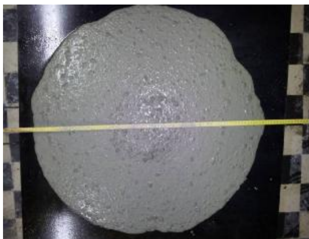
Slika 6.15 Pojava segregacije kod mešavine P7 sa 10% letećeg pepela
