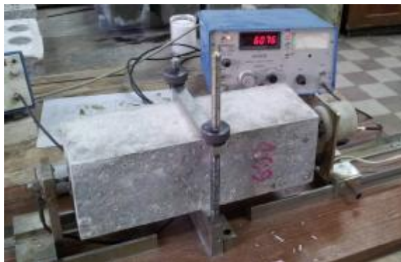
Slika 4.12 Aparatura za određivanje dinamičkog modula elastičnosti betona
