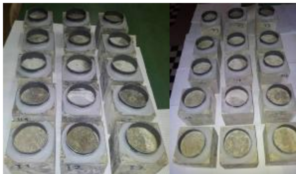
Slika 7.3 Uzorci pre (levo) i posle (desno) izlaganja dejstvu mraza i soli
