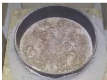
Slika 7.4 Uzorak E1-2 na kome su golim okom primetna neznatna oštećenja površine
