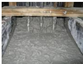
Slika 3.10 Samozbijajući beton sa izraženim blokiranjem pri testiranju L-boksom
