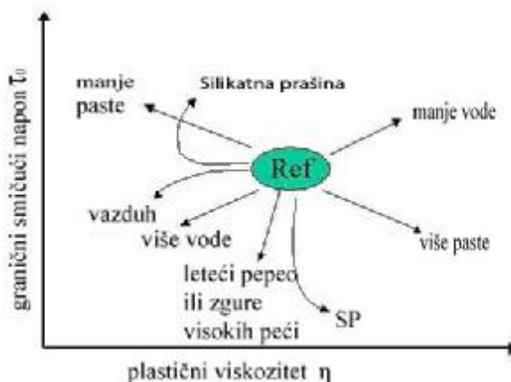
Slika 3.3 Efekti variranja komponentnih materijala na parametre Bingamovog modela kod svežeg betona [182]
