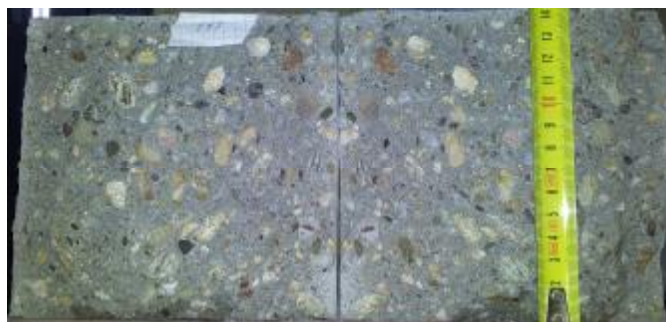
Slika 7.6 Poprečni presek uzorka sa tragom prodora vode (SCC sa spršenim recikliranim betonom)
