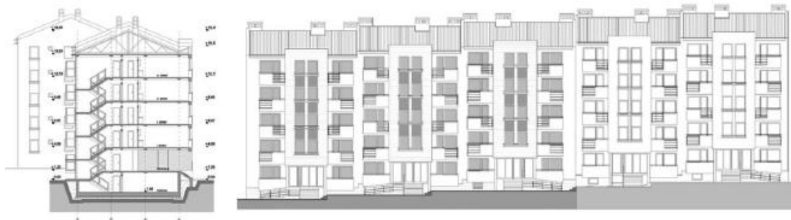
Слика 3.9: Објекти ЈРС у Нишу – Попречни пресек (доле лево) и Главна фасада (доле десно)
