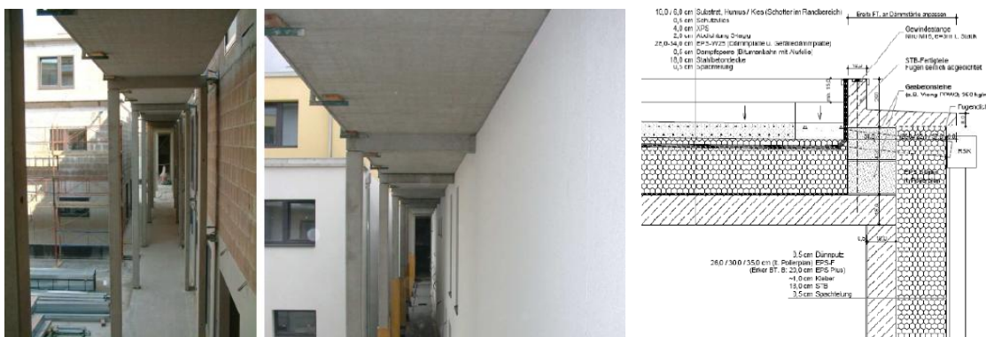
Слика 2.14: Архитектонско решење за елиминацију хладног моста
