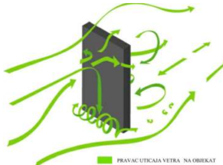
Слика 75. Утицај ветра на објекте високоградње (скица аутора)
