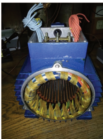
Сл. 5.4 – Премотани мотор са шестофазним намотајем
