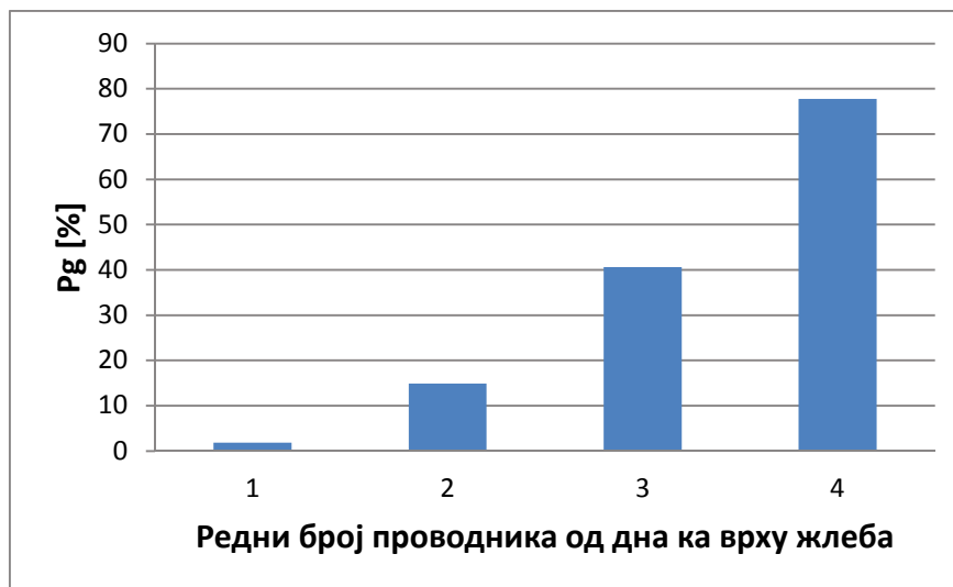
Сл. 2.12 - Процентуална вредност губитака у појединачним проводницима у случају протицања струје фреквенције 800 Hz у односу на случај са једносмерном струјом
