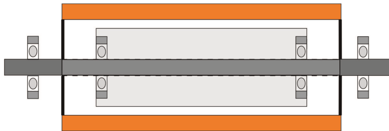
Сл. 4.13 – Двострано ослањање чаше (два система лежајева, унутрашњи за магнетско коло и спољашњи за осовину)
