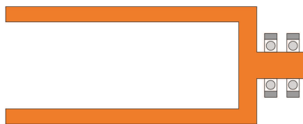
Сл. 4.10 – Једнострано ослањање чашастог ротора (систем од два лежаја)
