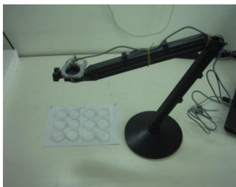
Слика 7. Апаратуре за генерисање променљивог магнетног поља и праћење локомоторне активности (А). Камера постављена изнад Петри шоља у којима су адулти D. subobscura (Б лево) и рачунар на ком се прати и обрађује локомоторна активност (Б десно)
