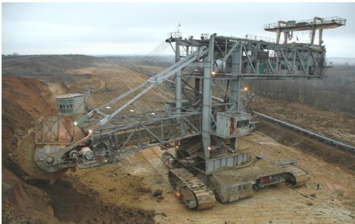
Slika 4.4. – rotorni bager SRs 1200x24/4x0 (400kW) + VR u toku eksploatacije jalovine
