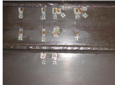
Sl.5.3 b) nosač A3 sa zadnje strane [70] sa rozetama (mr) i mernim trakama (mt)
