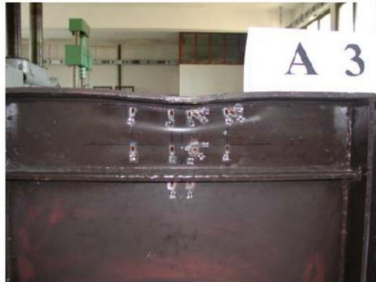
Sl.7.21e: Rezidualne deformacije nosača A3 iz eksperimenta Markovića (preuzeto iz [70])
