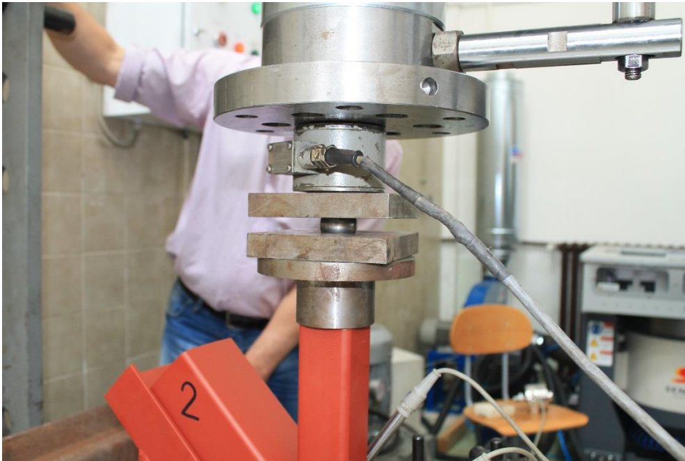
Slika 6.7 – Sferni oslonac posredstvom koga je centrično unošeno probno opterećenje
