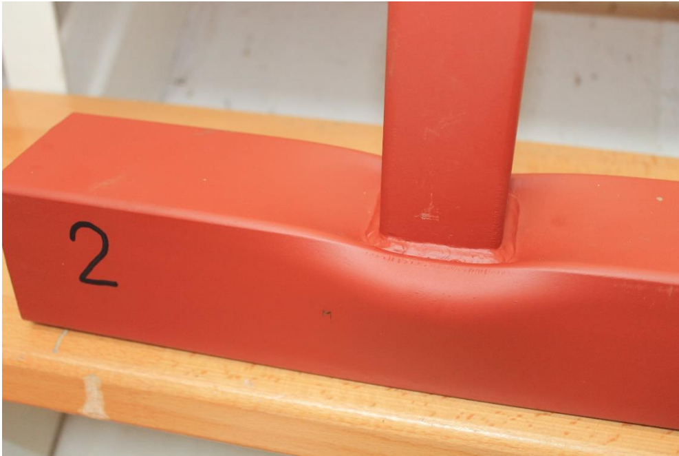
Slika 6.20 – Veza tipa „T“, uzorak broj 2 – trajne lokalne deformacije
