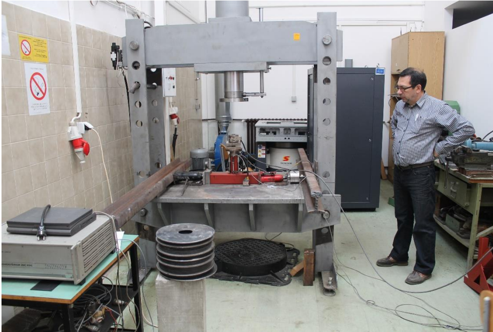
Slika 6.3 – Univerzalni ram za opterećenje sa hidrauličnim klipom, Laboratorija za Mehatroniku na Mašinskom fakultetu Univerziteta u Nišu
