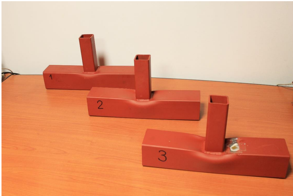
Slika 6.28 – Veza tipa „T“, uzorak broj 1, 2 i 3 uporedni prikaz nakon ispitivanja
