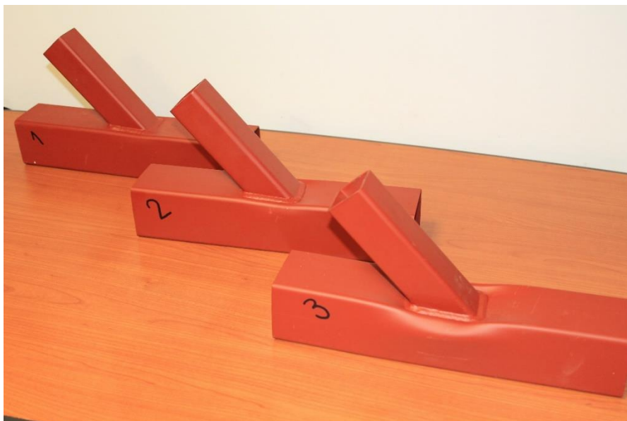
Slika 6.39 – Veza tipa „Y“, uporedni prikaz uzoraka broj 1, 2 i 3 nakon ispitivanja
