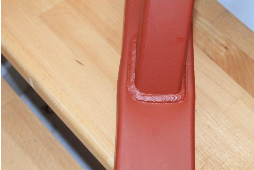
Slika 6.34 – Veza tipa „Y“, uzorak broj 2 – trajne lokalne deformacije
