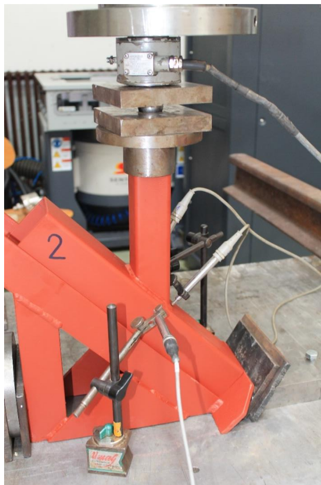
Slika 6.33 – Veza tipa „Y“, uzorak broj 2 – lokalne deformacije
