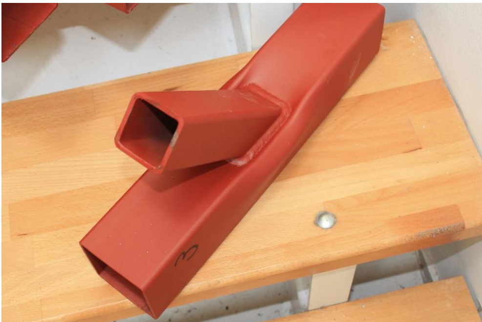
Slika 6.37 – Veza tipa „Y“, uzorak broj 3 – trajne lokalne deformacije
