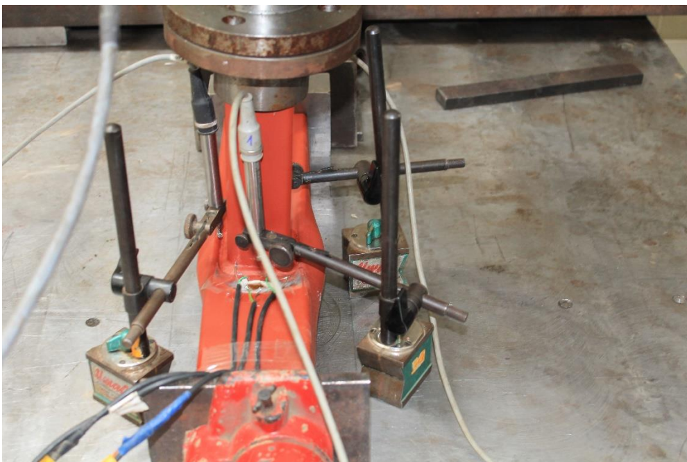
Slika 6.25 – Veza tipa „T“, uzorak broj 3 – trajne lokalne deformacije
