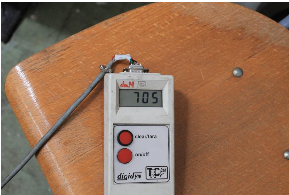
Slika 6.6 – Digitalni mobilni čitač unete aksijalne sile pritiska – DIGIDYN u pojasnim elementima
