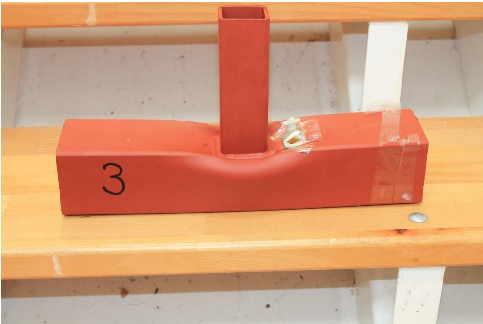
Slika 6.27 – Veza tipa „T“, uzorak broj 3 – trajne lokalne deformacije
