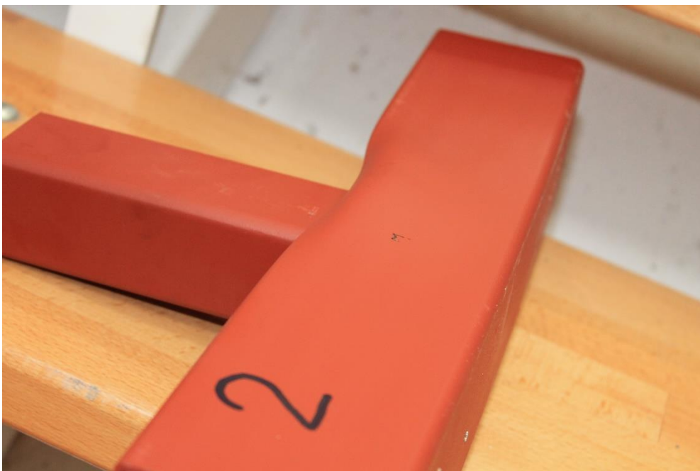
Slika 6.21 – Veza tipa „T“, uzorak broj 2 – trajne lokalne deformacije
