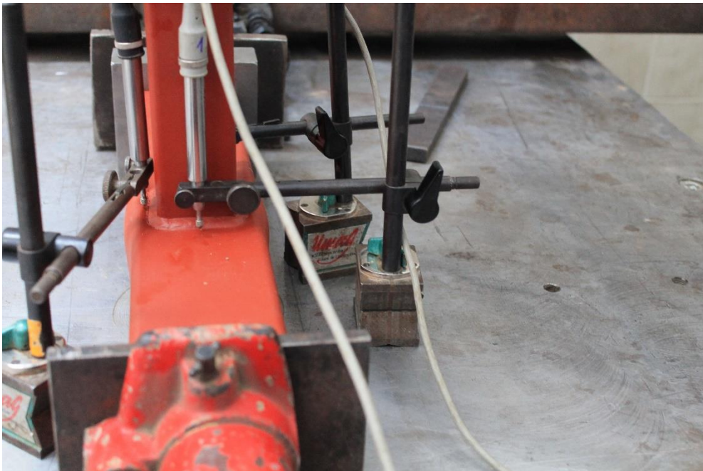
Slika 6.17 – Veza tipa „T“, uzorak broj 1 – lokalne deformacije (pogled u pravcu pojasnog štapa)
