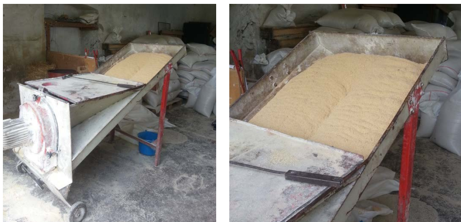
Слика 7. Припремање експерименталних смеша у мешалици хоризонталног типа коришћених у исхрани пилића
