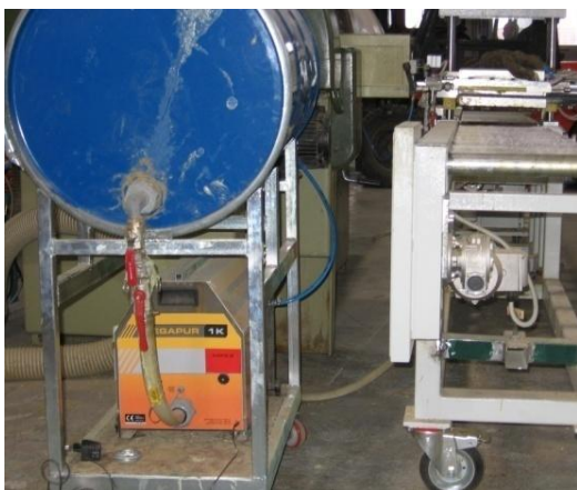
Slika 38. Mašina za nanošenje lepka ( Sretenovic P., 2015)
