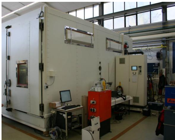
Slika 67. Komora za određivanje emisije formaldehida prema standardu EN 717-1
