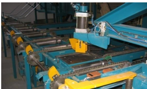
Slika 32. Automatski merač vlage sirovine (Sretenovic P., 2015)
