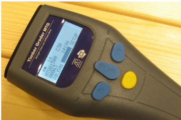
Slika 52. Merač modula elastičnosti drvenih lamela ( www.brookhuis.pl )
