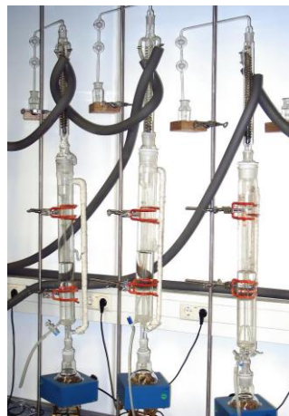
Slika 68. Aparatura za određivanje sadržaja formaldehida prema standardu EN 120
