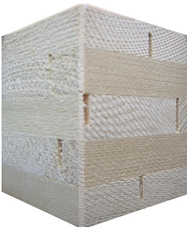
Slika 71. Petoslojni CLT smrče sa utorima za smanjenje naprezanja u drvetu (Izvor: Sretenović P.2014. Nemačka)
