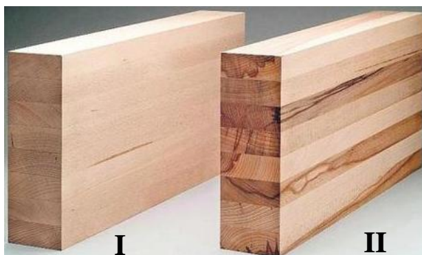
Slika 47. LLD bukve bez lažnog srca (I) i sa lažnim srcem (II) ( www.frankenpost.de )
