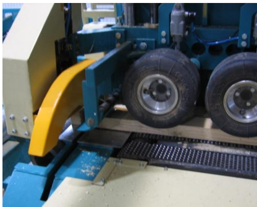
Slika 34. Mašina za dužinsko krojenje grešaka drveta (Sretenovic P., 2015)
