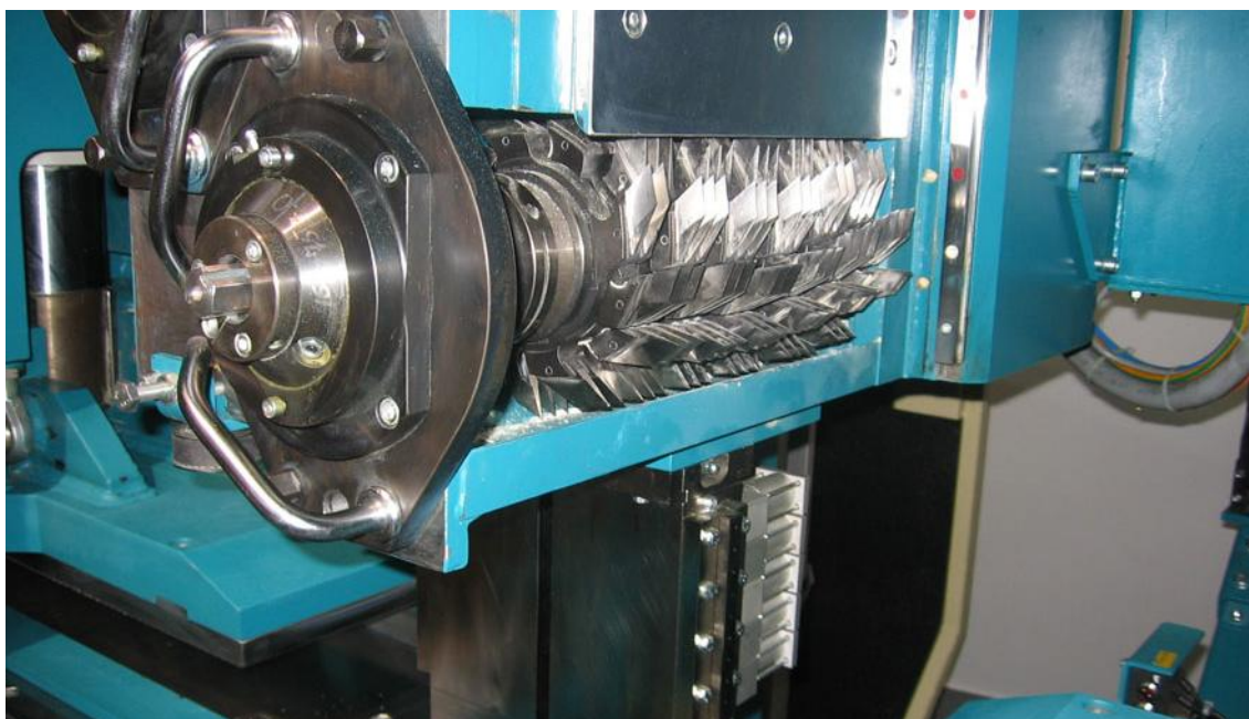
Slika 53. CNC mašina Eurozink/Ledinek za izradu zupčaste veze u lamelama za LLD (Izvor: Sretenovic P., Klagenfurt, 2010)
