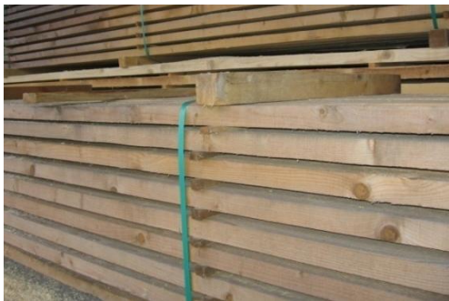
Slika 29. Sirova rezana građa za LLD (Sretenovic P., 2015)
