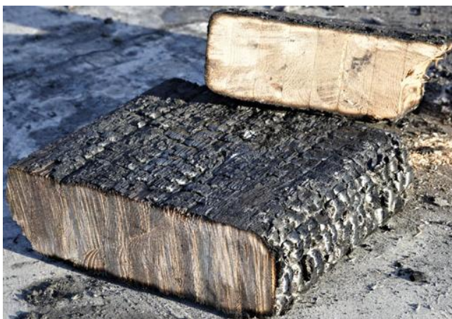
Slika 70. Ugljenisani zaštitni površinski sloj na LLD-u koji se formira u slučaju požara
