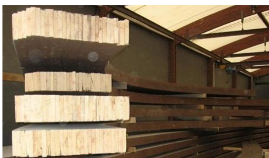
Slika 45. Zakrivljeni LLD dužine 23m, površinski zaštićen lazurnim premazom (Sretenovic P., 2015.)
