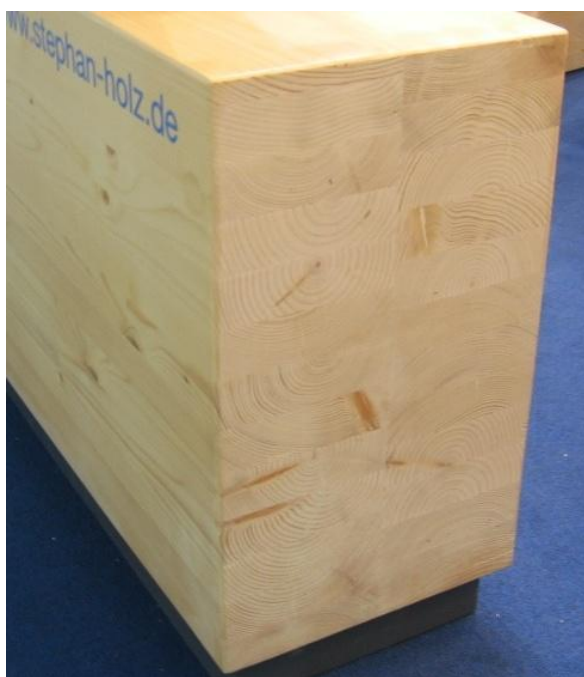
Slika 1. Lepljeno lamelirano drvo smrče po debljini i širini (Izvor: Sretenovic P., Minhen, 2013)
