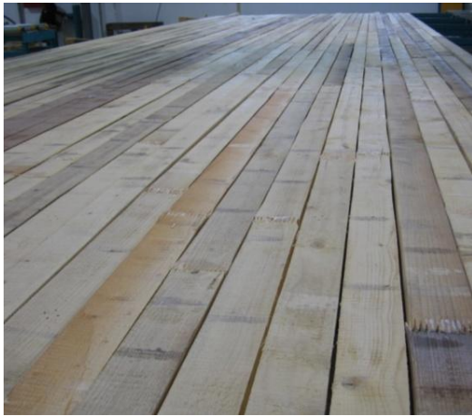
Slika 36. Dužinski nastavljene lamele ( Sretenovic P., 2015)
