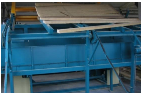
Slika 31. Rampa za doziranje suve daske (Sretenovic P., 2015)
