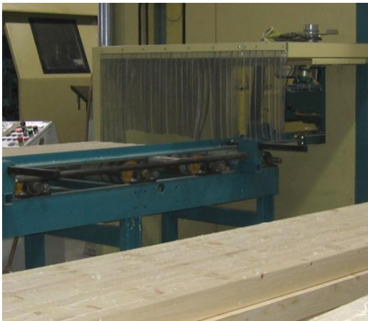
Slika 40. Četvorostrano rendisanje LLD ( Sretenovic P., 2015)
