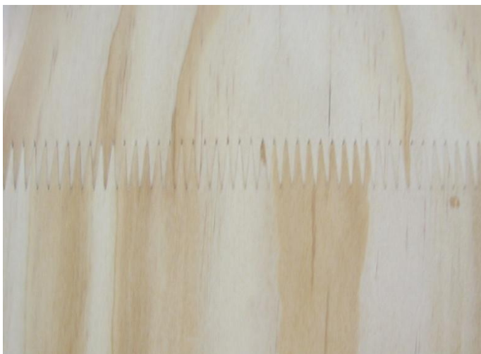
Slika 64. Klinasto-zupčasta veza lamela u LLD-u (Izvor: Sretenovic P., Minhen, 2013)
