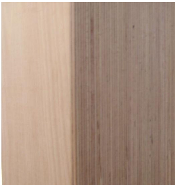
Slika 5. Lamelirana furnirska građa bukve (Izvor: Sretenovic P., Minhen, 2013)
