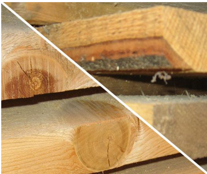
Slika 43. Nedoovoljene greške drveta u rezanoj građi namenjenoj izradi LLD-a (Izvor: Sretenovic P., 2015)
