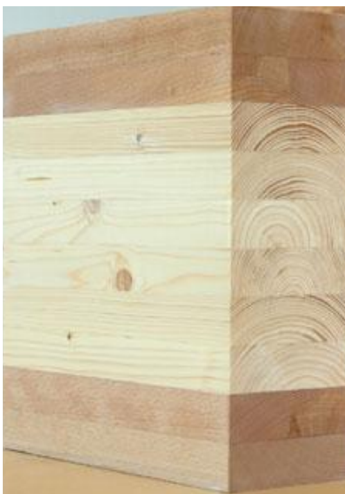
Slika 3. Hibridni LLD bukve i smrče
