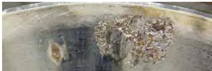
Slika 5.7. Oštećenja ležaja uzrokovana proticanjem lutajućih struja stranih izvora [94]
