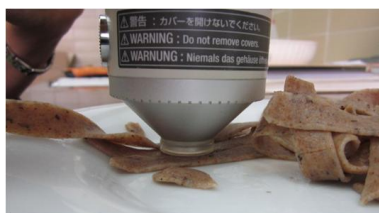
Slika 3.4. Merenje boje kuvane testenine pomoću kolorimetra Minolta Chroma Meter CR-400
