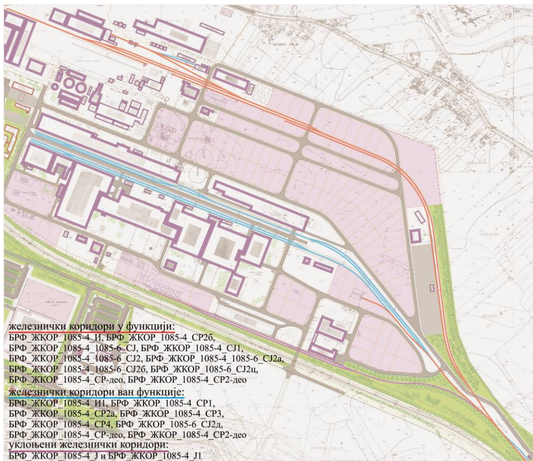
Слика 4.18: Стање индустријских железничких коридора Пословне зоне а.д. Бања Лука
