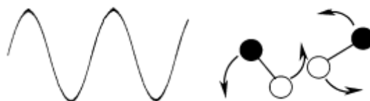
Slika 2.11. Dipolarni molekuli koji nastoje da se orijentišu u pravcu oscilujućeg električnog polja
