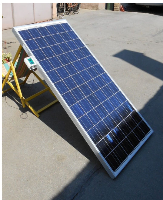
Slika 2.12 – Senčenje tri zone FN panela
