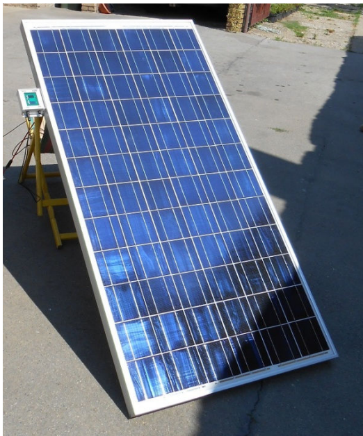
Slika 2.11 – Senčenje dve zone FN panela
