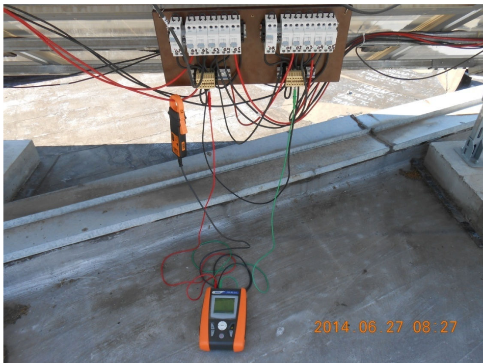
Slika 8.12 – Merenje parametara FN niza sa uređajem Solar I-V
