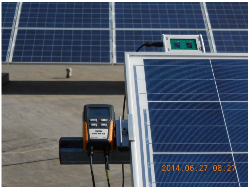
Slika 8.10 – Senzor zračenja postavljen na južnom FN nizu
