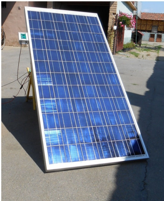
Slika 2.10 – Senčenje jedne zone FN panela
