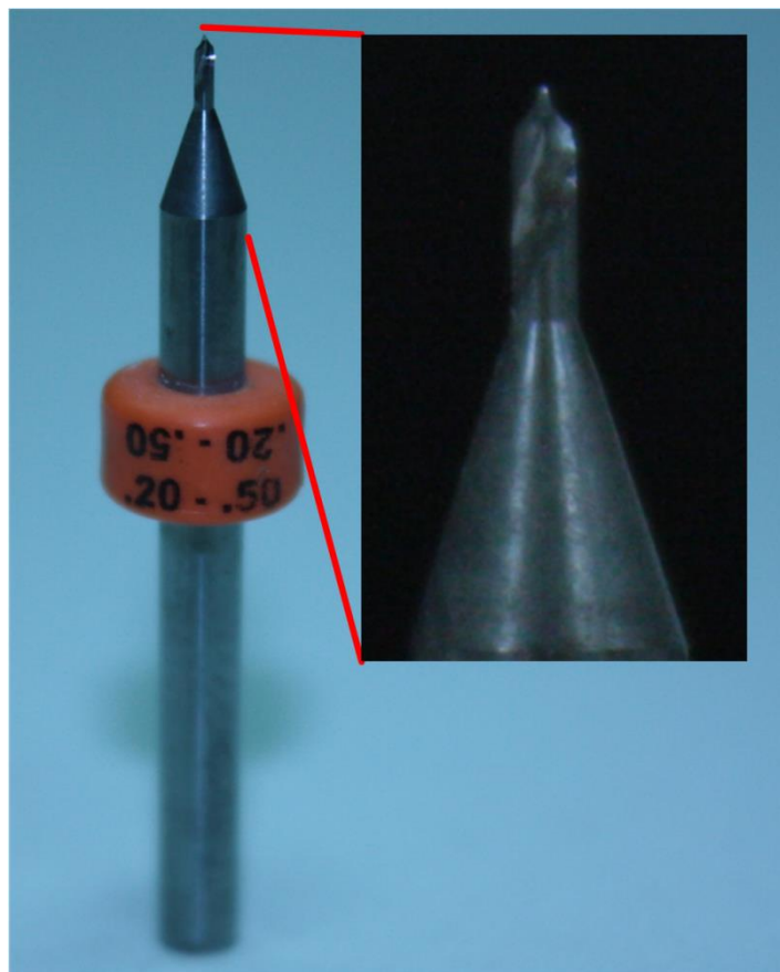
Slika 3.24. Fotografija alata kojim su izrađeni senzori (eng. universal cutter tool ).
