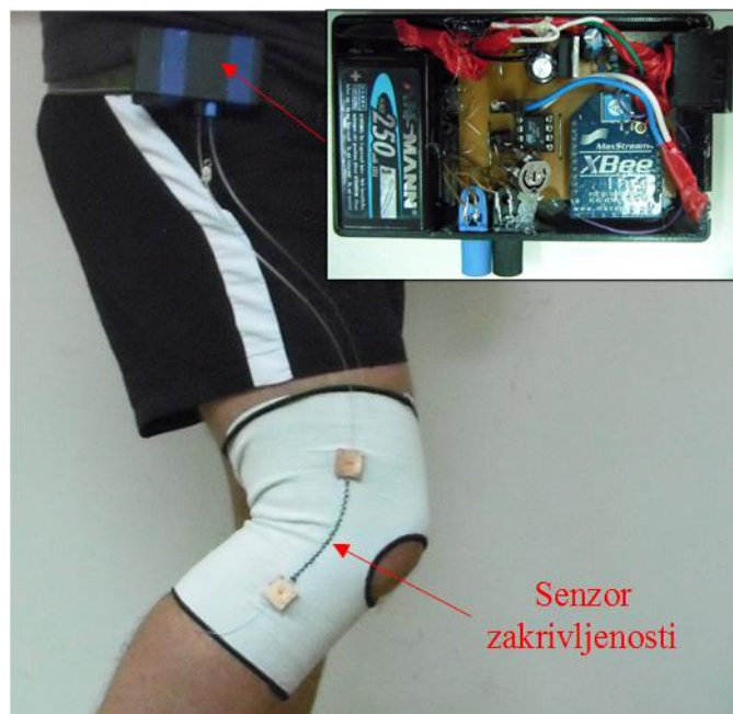
Slika 5.4. Fotografija realizovanog fiber-optičkog senzorskog sistema. Elektronski uređaj je upakovan u kutiju, na fotografiji se vidi i unutrašnjost uređaja [102].
