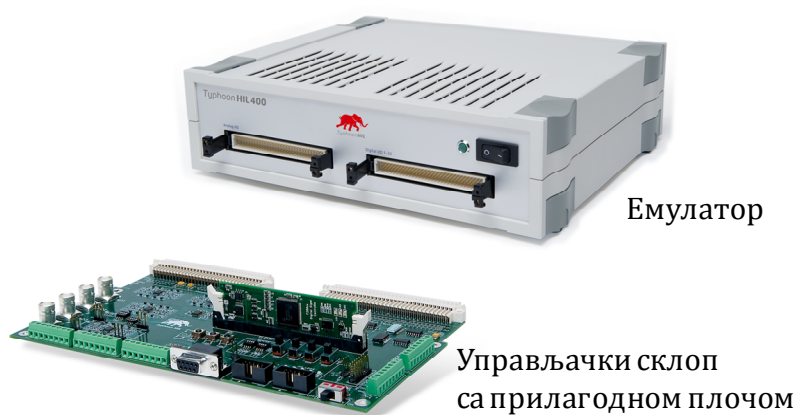
Слика 1.4: Управљачки склоп повезан на емулатор
