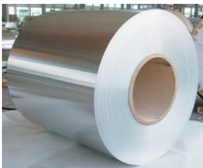
Slika 7. Izgled aluminijumskih rolni od kojih se izrađuju ofset ploče
