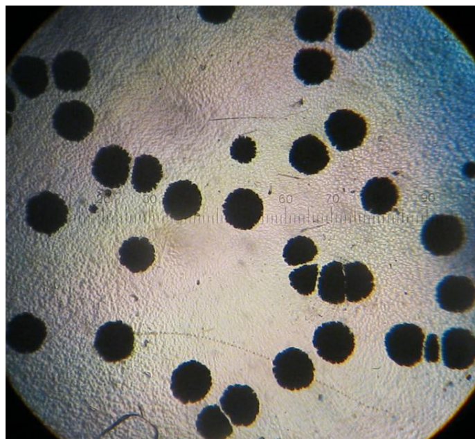
Слика 3.4 Трагови алфа-честица радона и његових потомака на Макрофол детектору, након електрохемијског нагризања. Фотографија је добијена у Лабораторији за радијациону физику ПМФ-а Универзитета у Крагујевцу
