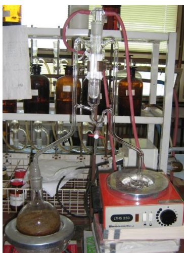
Слика 33. Апаратура по Ликенс-Никерсону за симултану дестилацију/екстракцију ароматичних материја плодова шљиве
