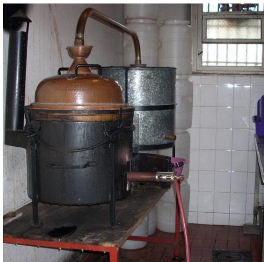
Слика 36. Лабораторијски апарат за дестилацију шарантског типа запремине 25 литара
