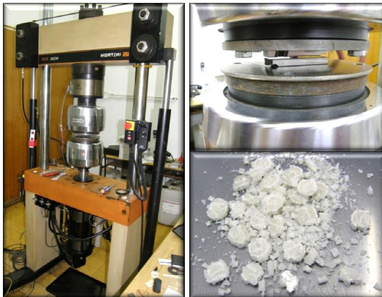
Slika 22. Instron uređaj za merenje kompresivne čvrstoće, sa prikazom mesta za postavljanje uzorka i polomljenih uzoraka nakon testiranja
