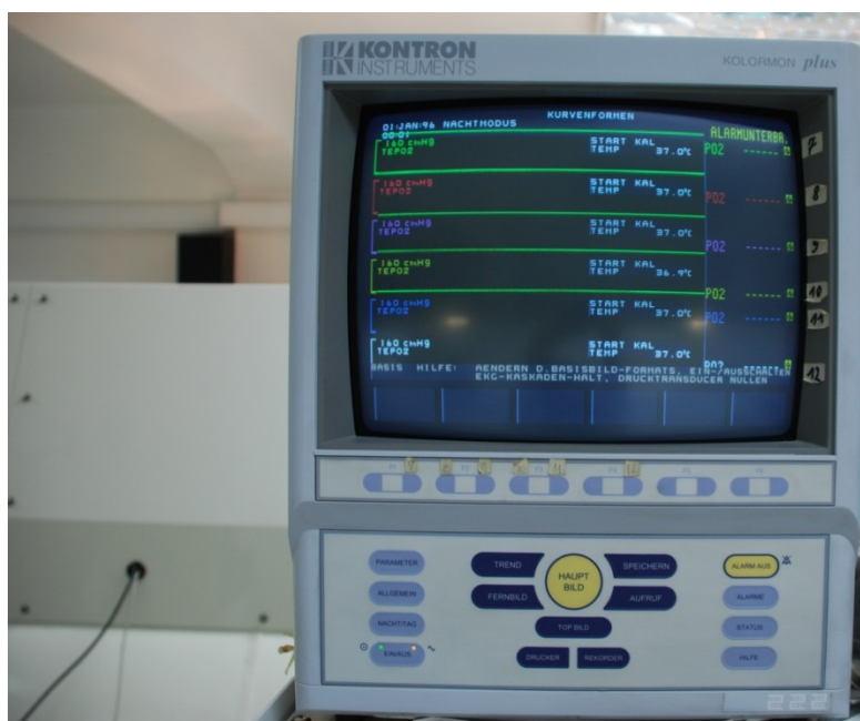
Слика 5.3. KONTRON KolormonPlus монитор за транскутано мерење парцијаног притиска кисеоника у ткиву (Специјална болница за хипербаричну медицину, Београд)
