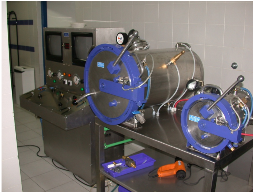
Слика1.10. Експерименталне коморе за мале животиње са командним пултом Произвођач Специјална болница за хипербаричну медицину, Београд (Институт за медицинску физиологију „Рихард Бурјан“ Медицинског факултета, Београд)
