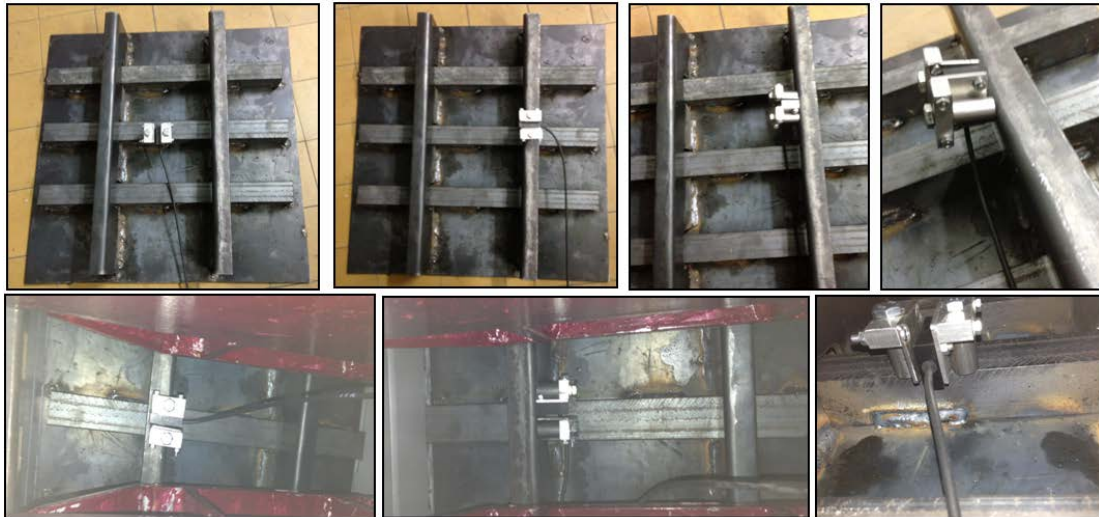
Слика 7.17. Бесконтактни сензор ( Eddy – Current ), на Моделу 3
