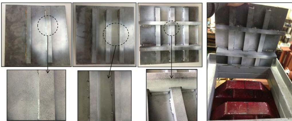
Слика 7.22. Припремљена мерна површина за оптичко мерење
