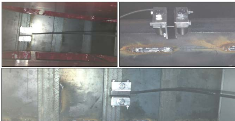
Слика 7.16. Бесконтактни сензор ( Eddy – Current ), на Моделу 2
