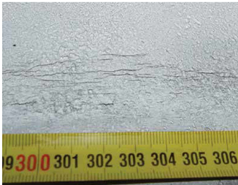
Слика 6.18. Изглед прслина на прелазном радијусу – испитивано течним пенетрантима
