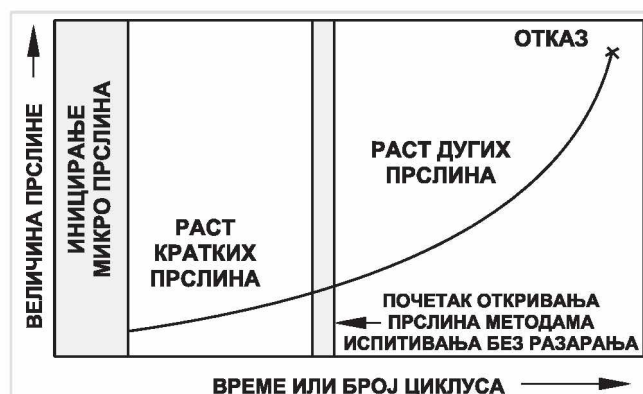
Слика 4.5. Преглед свих фаза при замору и њихова веза са бројем циклуса
