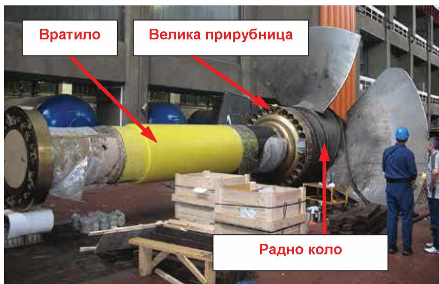
Слика 6.6. Изглед турбинског вратила пре монтаже
