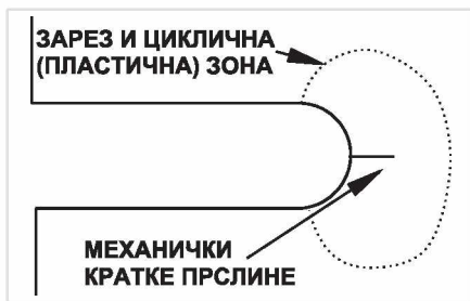
Слика 4.6. Схематски приказ механички кратких прслина
