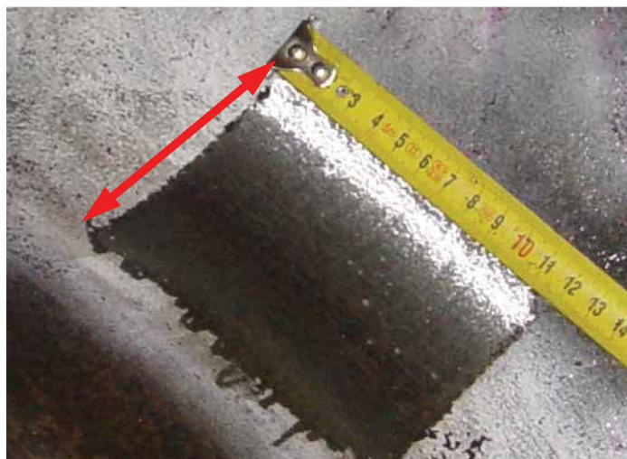
Слика 6.20. Димензије зоне у којој су се појавиле прслине, снимак након пробног брушења
