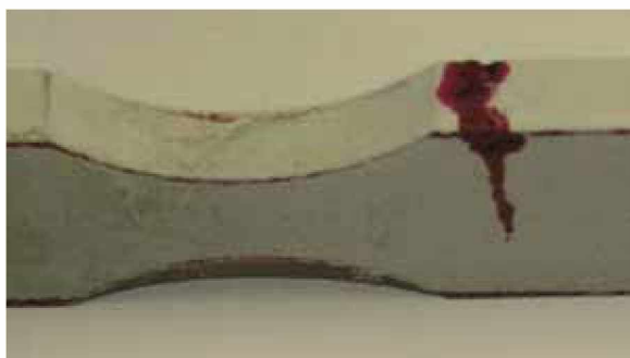
Слика 5.12. Порозност материјала епрувете код које је настала прслина при испитивању замарањем
