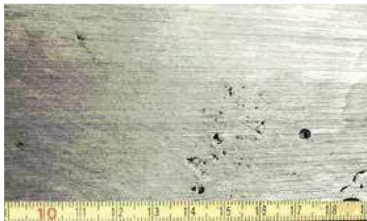
Слика 6.10. Уочена порозност на исеченим узорцима [201]
