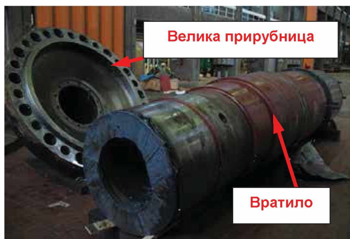
Слика 6.7. Изглед турбинског вратила након демонтаже и сечења
