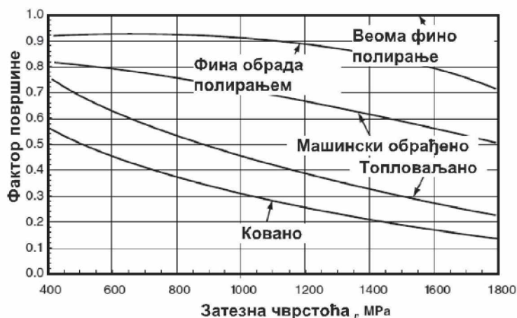
Слика 2.11. Утицај квалитета површине на затезну чврстоћу чврстоћу [78]
