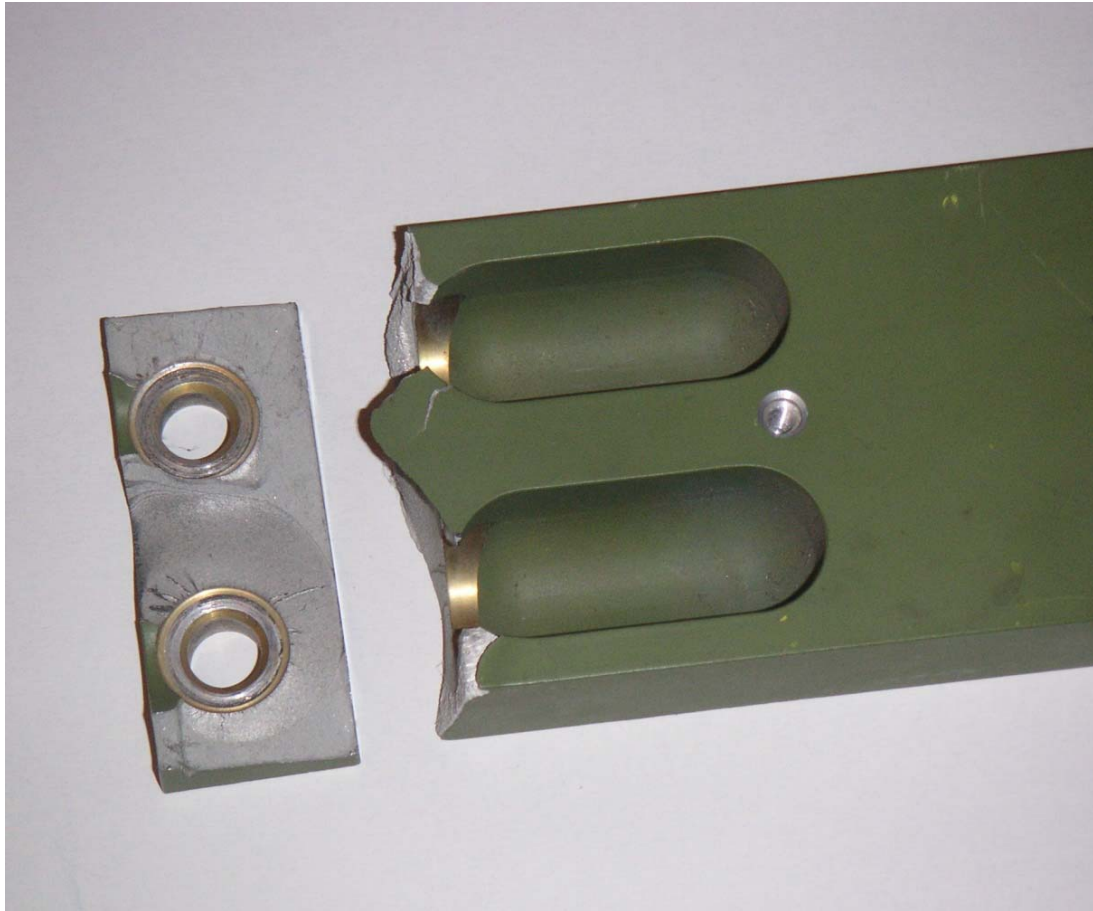
Слика 9.6.3. - Изглед лома после испитивања на замор дела везе крило-труп авиона
