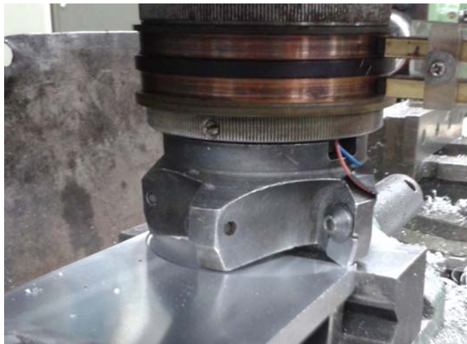
Slika 3.3. Glava za glodanje sa izmenljivim reznim pločicama G.037 \phi 100 mm
