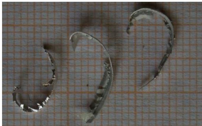
Slika. 6.10. Oblik strugotine dobijene eksperimentalnim putem
