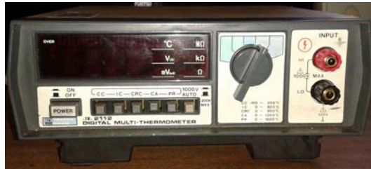
Slika. 3.14. Digitalni multi-termometar TR 2112
