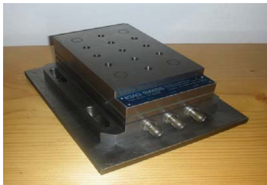
Slika 3.6. Piezoelektrični trokomponentni dinamometar “KISTLER” 9257A
