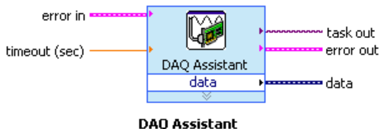
Slika 3.20. Interaktivni vodič za konfigurisanje, testiranje i prikupljanja mernih podataka
