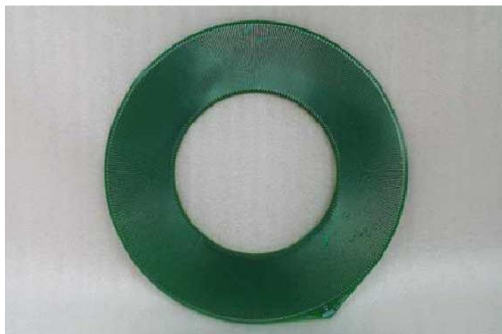
Слика 4.71 Калем Роговског направљен од вишеслојне штампане плоче
