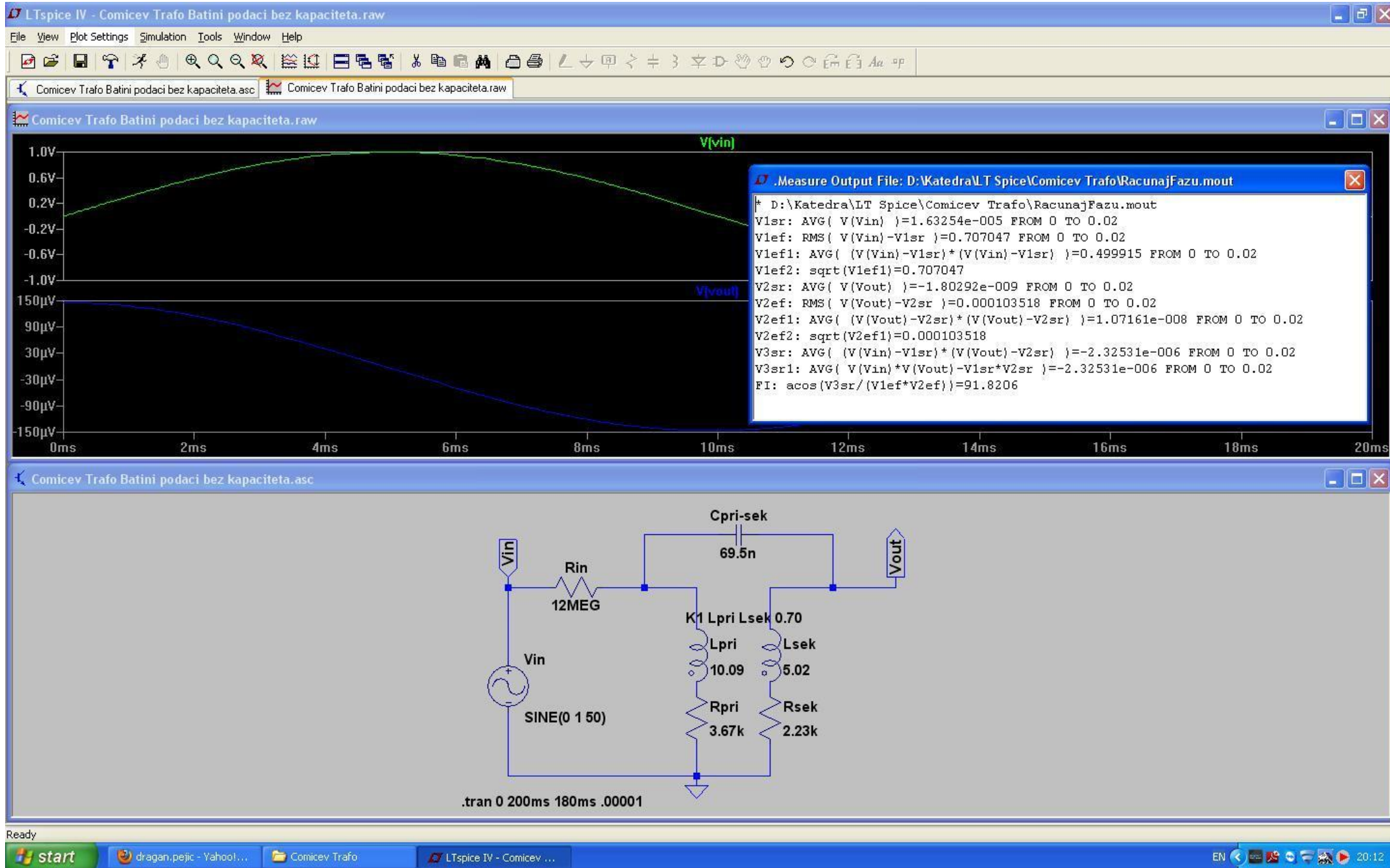
Слика 4.59 Симулација са капацитивношћу од 69.5 nF
