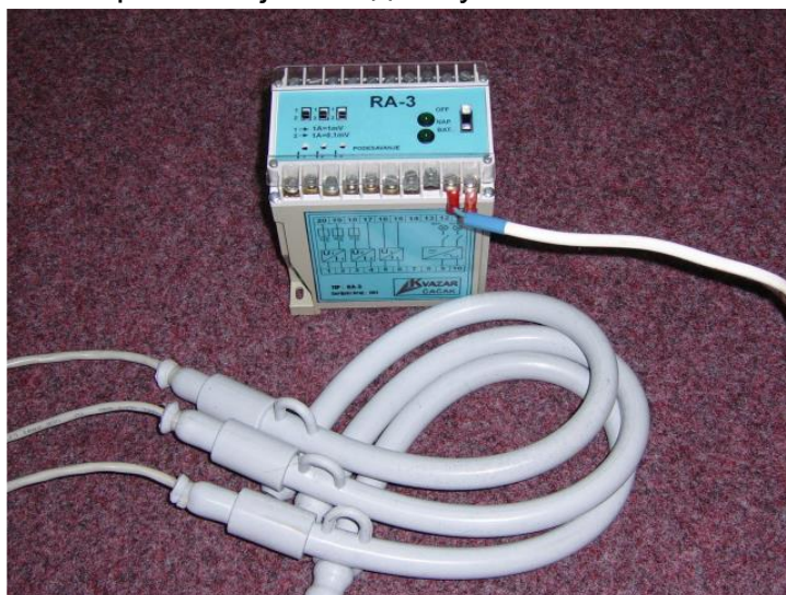
Слика 4.74 Калем Роговског који се поставља на голи ВН проводник
