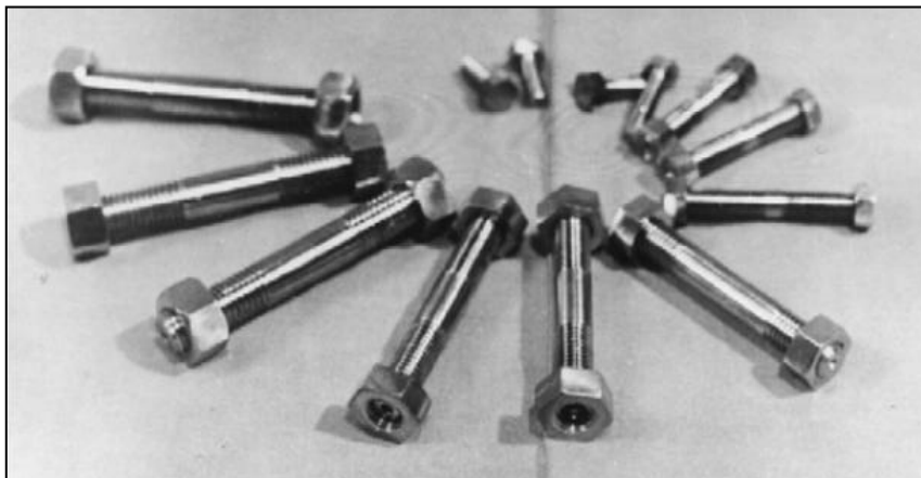
Slika 2.44. Zavrtnji visoke čvrstoće od titanijumske legure dobijeni ECAP-om [166]
