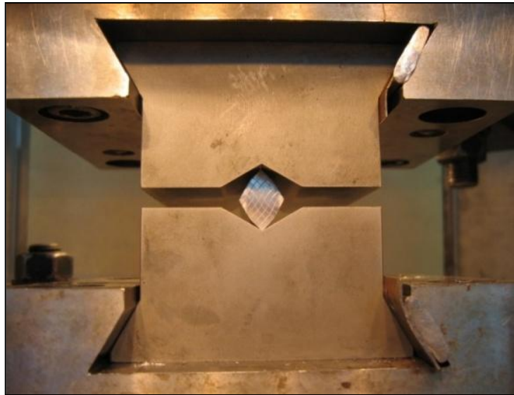
Slika 4.11. V-alat za višefazno sabijanje postavljen na hidrauličnu presu
