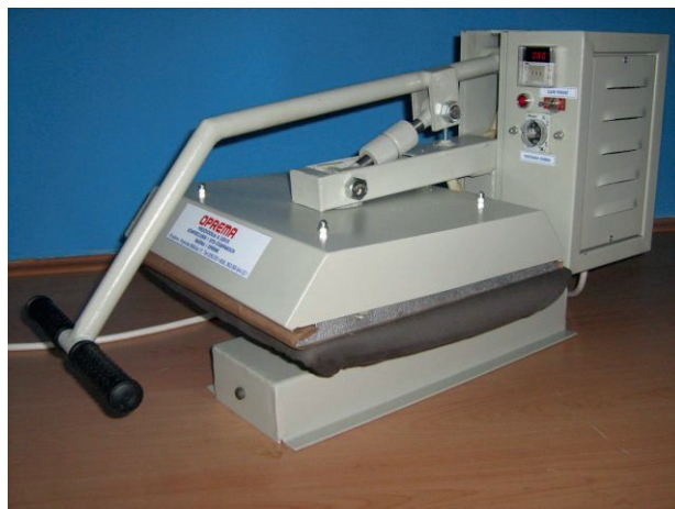
Slika 6.3. Uređaj za sušenje otisaka tp 4040s (Opremakv, 2008)
