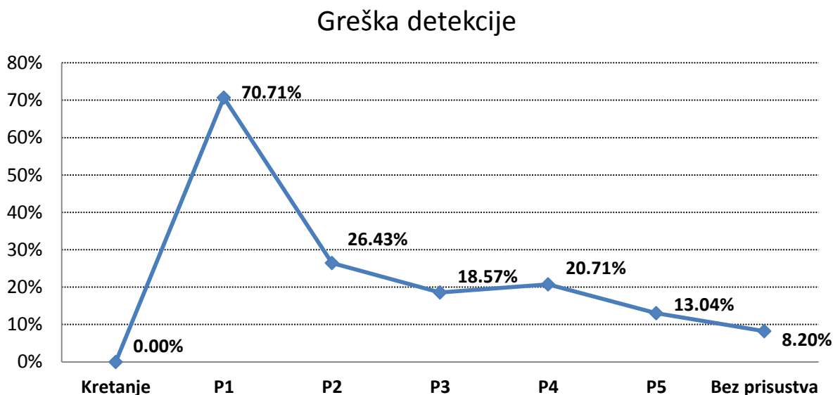
Slika 19. Greška detekcije u Z1 za dužinu niza od p = 12 odbiraka kliznog prozora matrice X izračunata kao odnos ukupnog broja baznih komponenti tokom određene pozicije ili kretanja u odnosu na broj baznih komponenti čije vrednosti nedozvoljeno prelaze granicu detekcije – ukoliko su u slučaju prisustva niže, odnosno u slučaju odsustva više.
