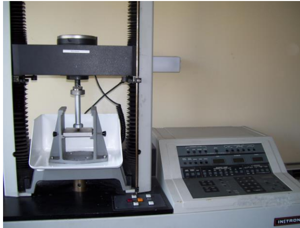
Slika 4.2.2. Univerzalni Instrument za mjerenje teksture - Instron 014-405
