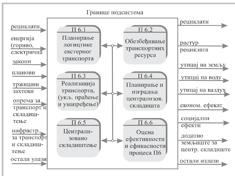
Слика 7.10. Декомпозиција процеса екстерног, транспорта и централизованог одлагања рециклата
