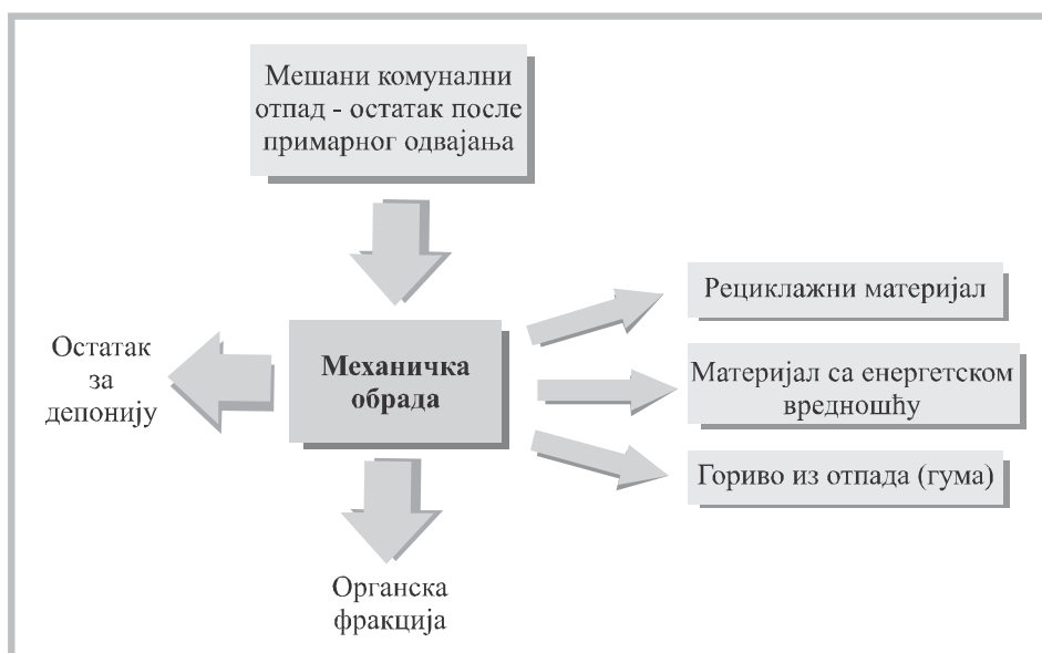
Слика 4.2. Input/output анализа за механичку обраду комуналног отпада
