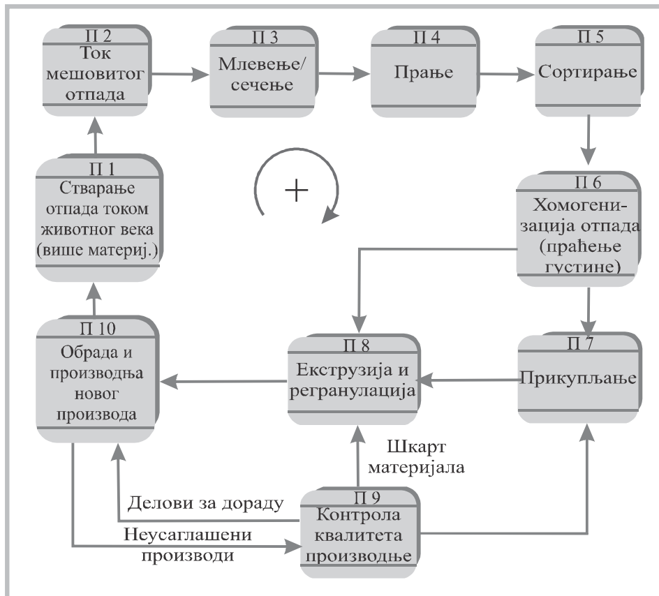
Слика 6.16. Ток производње делова од рециклиране пластике
