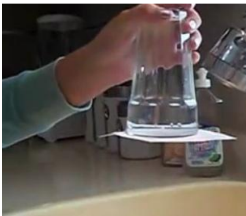
Слика 21. Демонстрација атмосферског притиска
